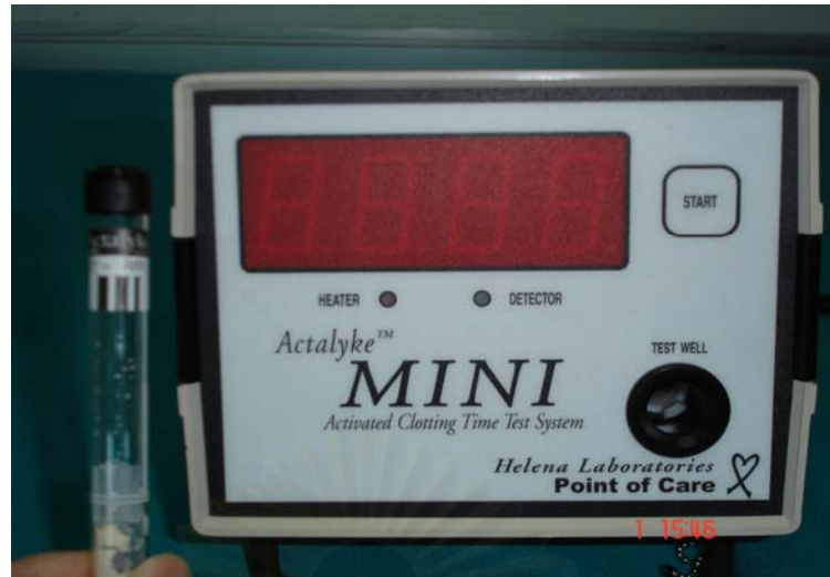
รูปที่ 2 รูปเครื่องตรวจนับระยะเวลาการแข็งตัวของเลือดและหลอดบรรจุเลือดที่ใช้ในการศึกษา
