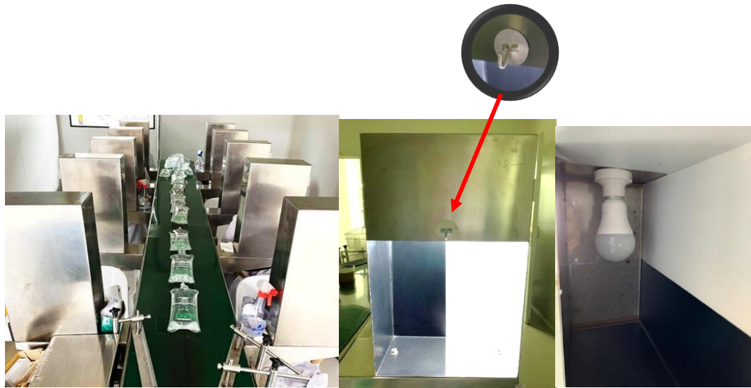
ภาพที่ 3.2 ตู้ตรวจอนุภาค และตำแหน่งติดตั้งตะขอแขวน
