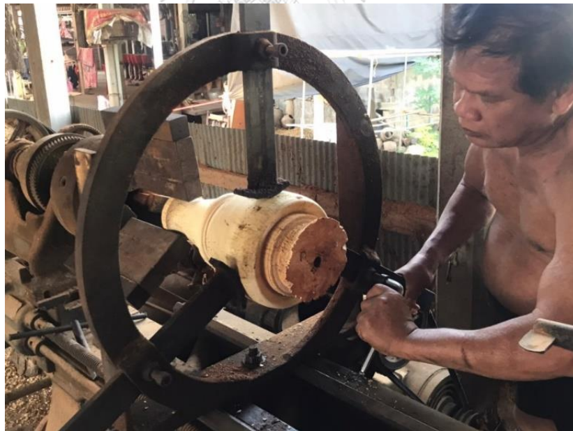
ภาพที่ 98 ช่างสุวรรณ์ติดตั้งหุ่นโหนดชาตรีบนเครื่องคว้าน ที่มาภาพ: ผู้วิจัย
