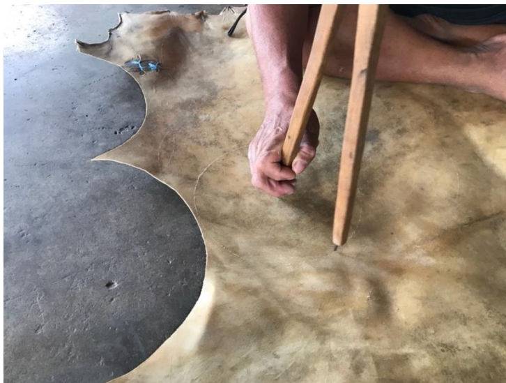
ภาพที่ 108 ใช้วงเวียนกำหนดบริเวณหนังที่ต้องการ
