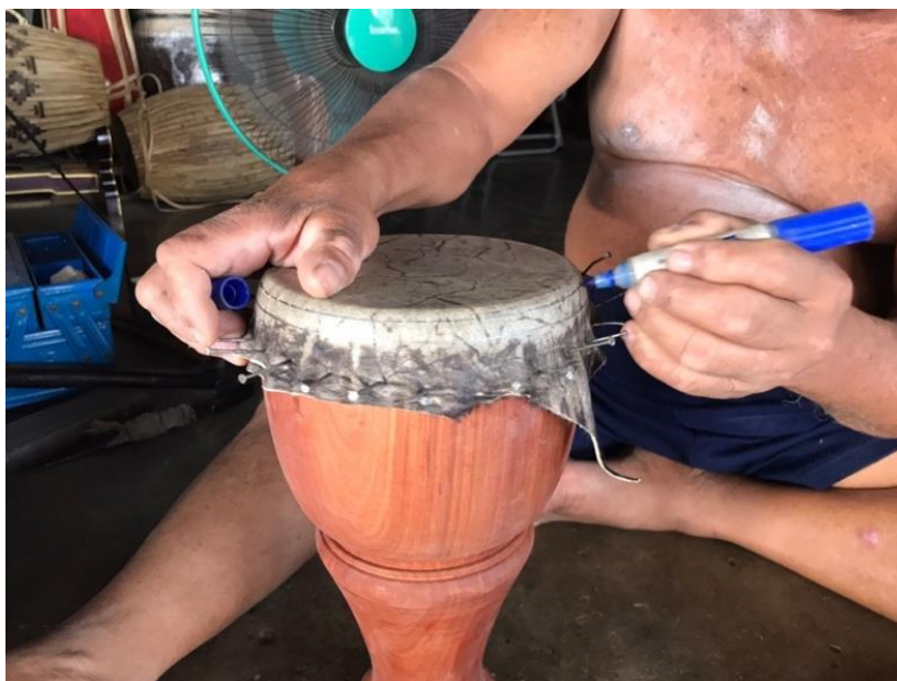
ภาพที่ 119 ใช้ปากกาเคมีช่วยจุดเพื่อให้เกิดความชัดเจน ที่มาภาพ: ผู้วิจัย
