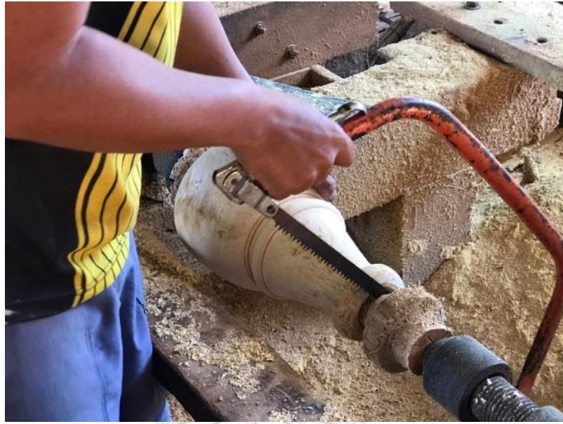
ภาพที่ 97 นายยุทธนาเลื่อยหุ่นโหนดชาตรีที่กลึงเสร็จแล้วออกจากแท่นกลึง ที่มาภาพ: ผู้วิจัย
