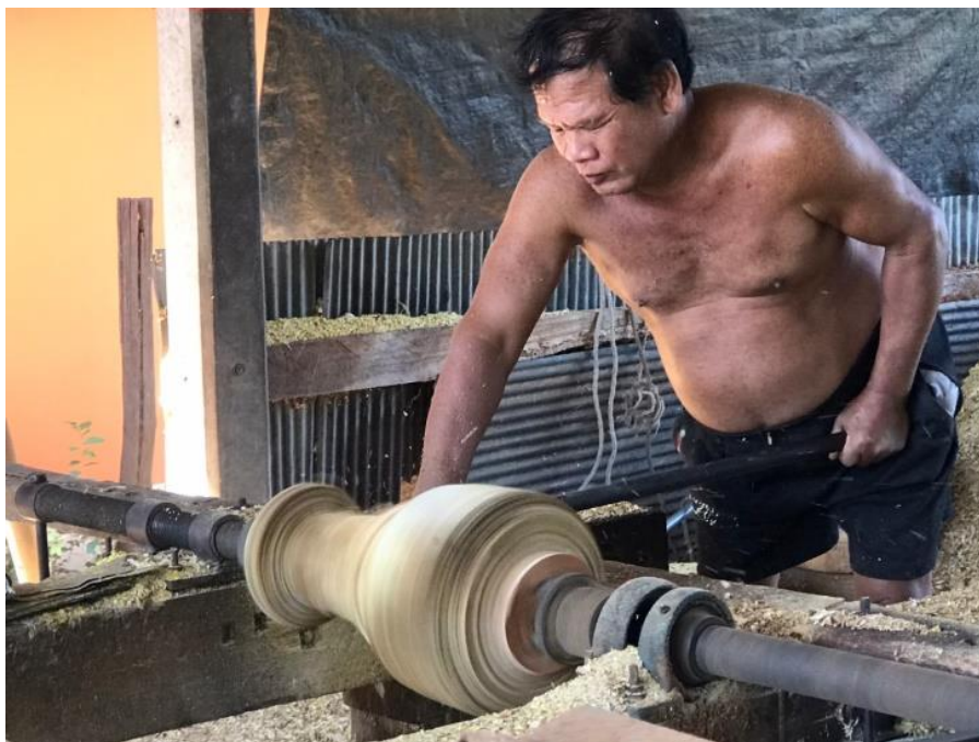
ภาพที่ 91 ช่างสุวรรณกำลังกลึงให้ได้รูปทรงของโทนชาตรีในเบื้องต้น
