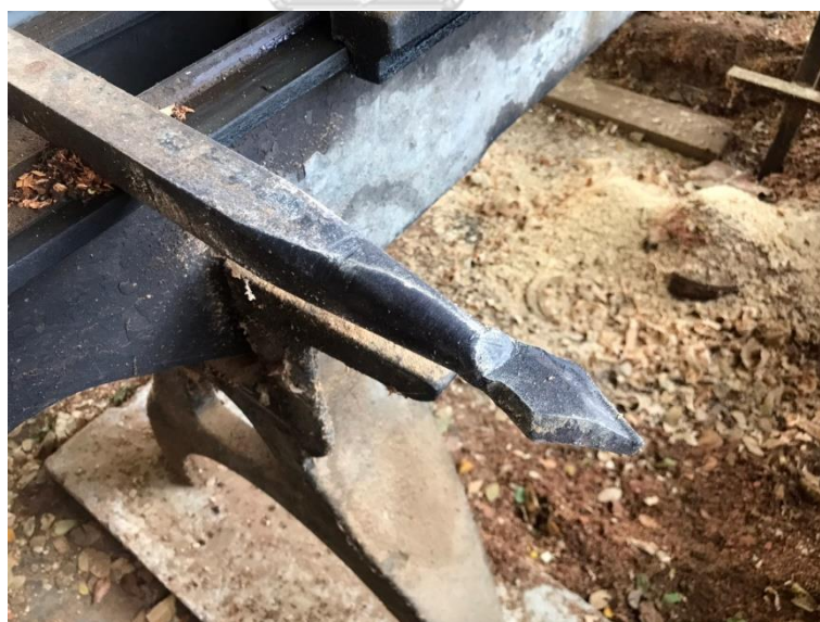
ภาพที่ 58 เหล็กคว้านหัวใบพาย ที่มาภาพ: ผู้วิจัย
