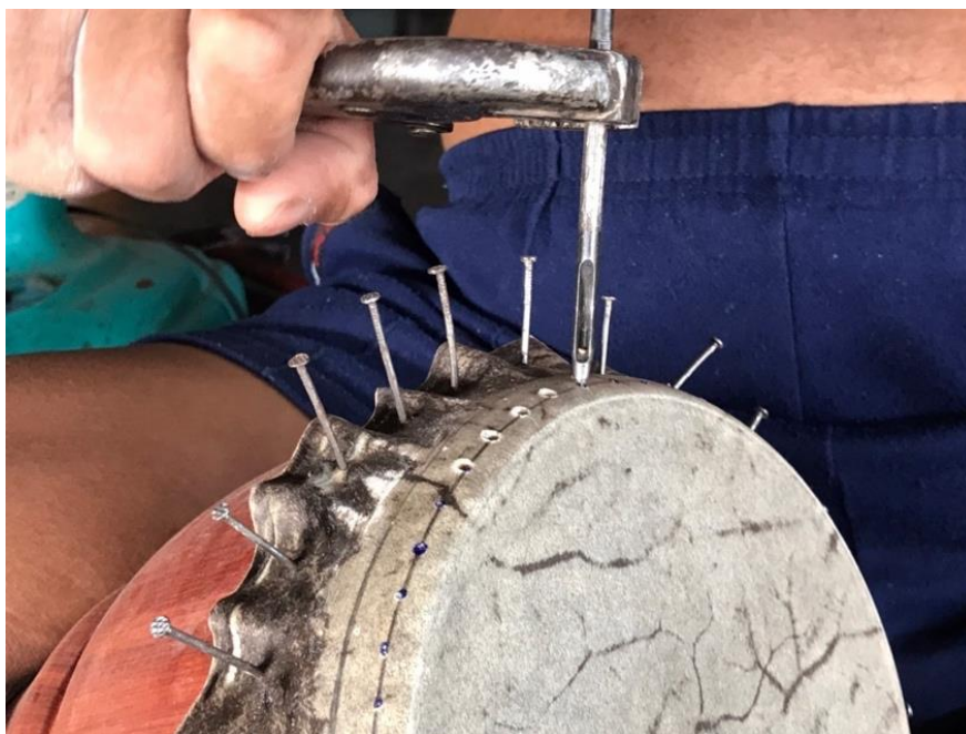
ภาพที่ 120 ใช้เหล็กตุดตู่ในการตอกหนัง
