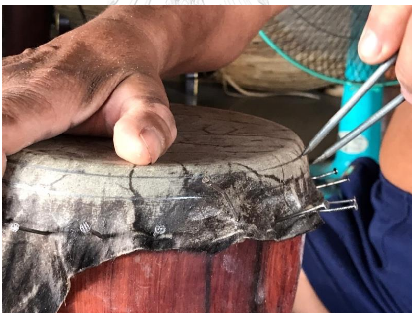
ภาพที่ 118 ใช้เหล็กกล้ามปูในการกำหนดจุดร้อยไล่ละมาน ที่มาภาพ: ผู้วิจัย
