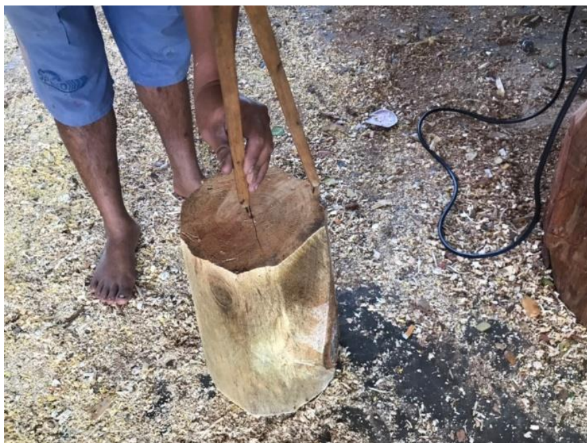
ภาพที่ 87 กำหนดจุดกึ่งกลางของไม้ก่อนขึ้นเครื่องกลึง
