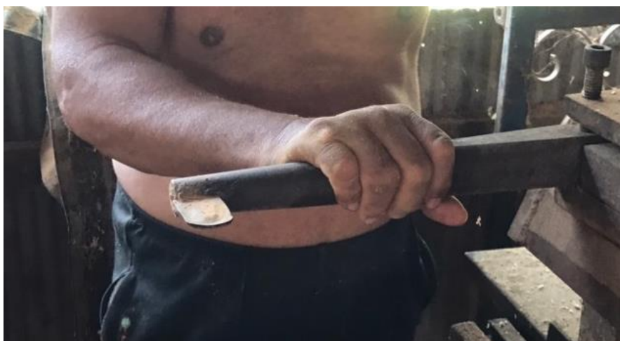
ภาพที่ 102 เปลี่ยนเหล็กคว้านเป็นหัวโค้งมน ที่มาภาพ: ผู้วิจัย
