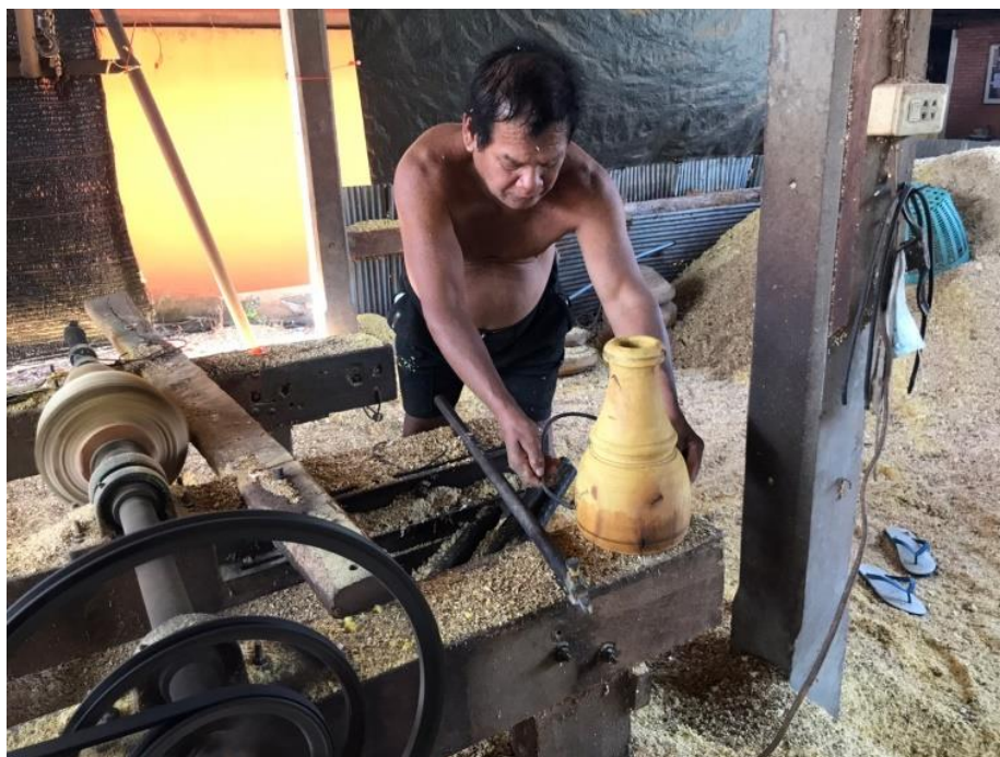
ภาพที่ 92 ช่างสุวรรณ์ขณะวัดส่วนหม้อจากหุ่นโทนชาตรีต้นแบบ ที่มาภาพ: ผู้วิจัย
