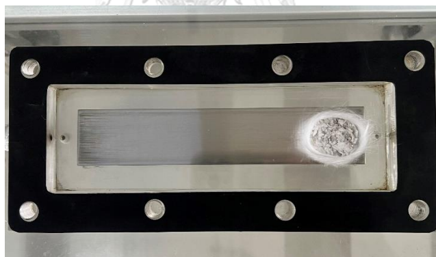
รูปที่ 3.11 ภายถ่ายรูปแบบการบรรจุตัวเร่งปฏิกิริยาแบบบางส่วนในเครื่องปฏิกรณ์พลาสมา
