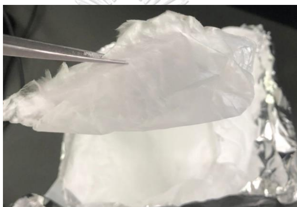
รูปที่ 3.2 ภาพถ่ายตัวร่งรับเส้นใยซิลิกาหลังการเผาคล้ไซน์ที่อุณหภูมิ 500°C เป็นเวลา 2 ชั่วโมง
