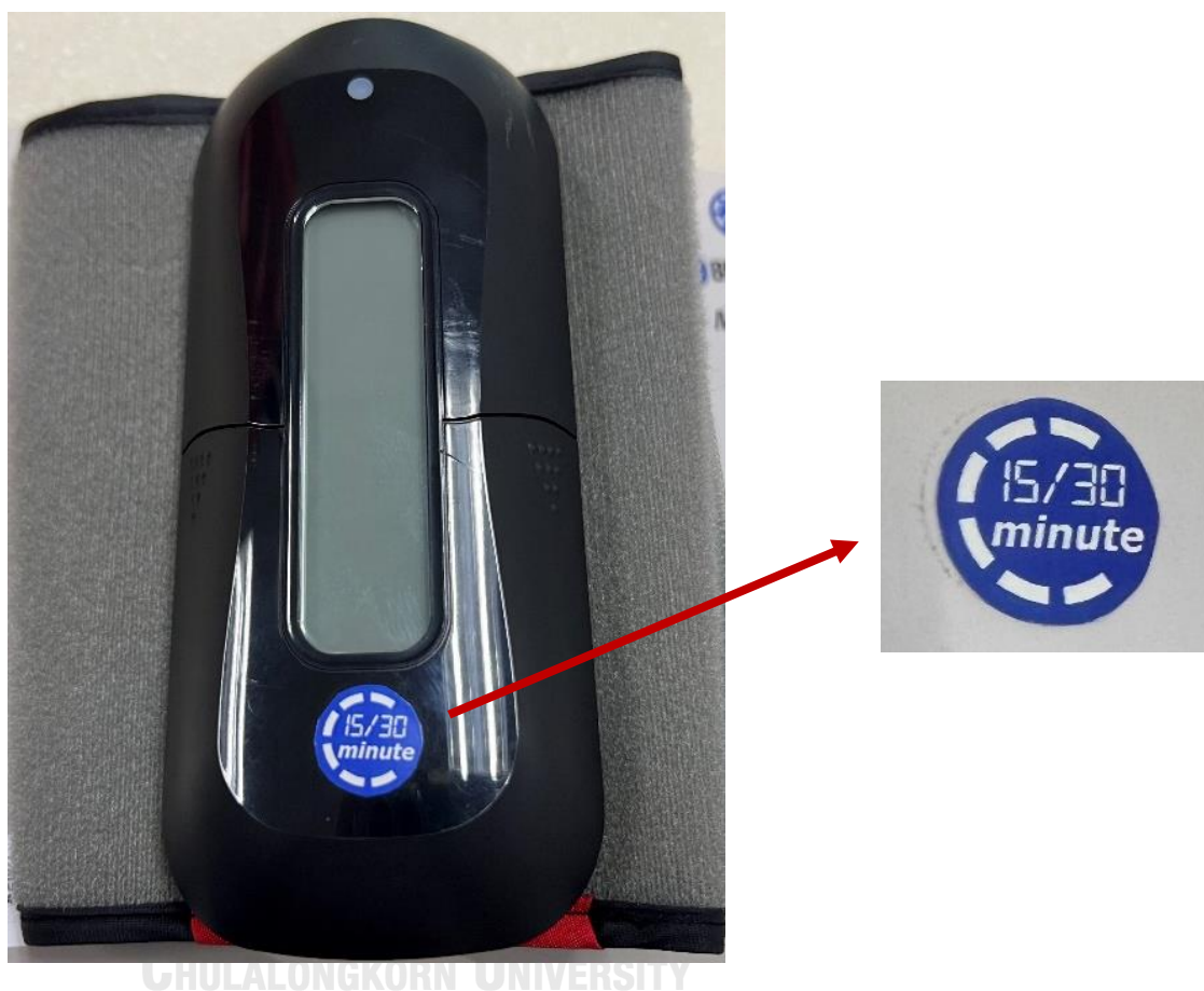
รูปภาพที่ 7 เครื่องวัดความดันโลหิตแบบไร้สายชนิดพกพา รุ่น “Uright® model 3127AT, TaiDoc Technology Corporation” ที่ถูกติดตั้งเครื่องตั้งเวลาในการวัดความดันโลหิตได้ทุก 15 หรือ 30 นาที
