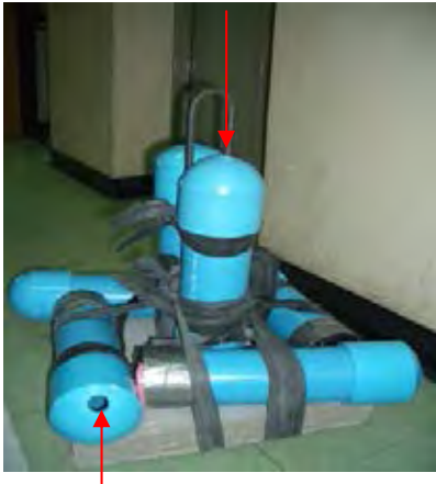
รูปที่ 6.45 เครื่องดักตะกอน
