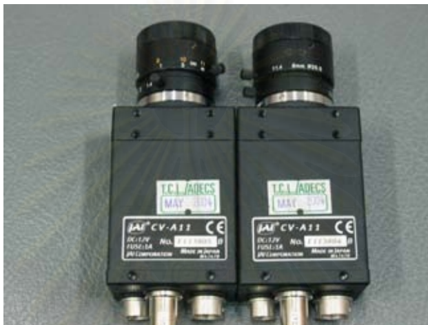
รูปที่ ก.1 กล้องวิดีโอโปรเกรสซีฟสแกนชนิดสีเทายี่ห้อ JAI รุ่น CV-A11
