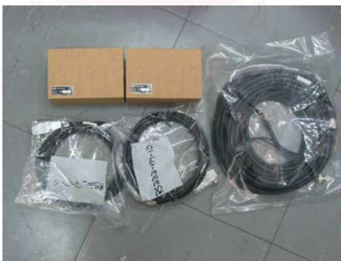
รูปที่ ก.2 สายเคเบิลเชื่อมต่อสัญญาณระหว่างแผ่นวงจรจับภาพ กล้องวิดีโอและคอมพิวเตอร์
