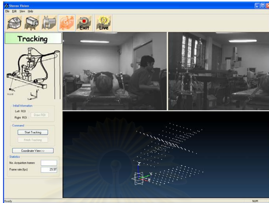
รูปที่ ข.4 โปรแกรมประยุกต์ในส่วนของการแสดงผลการคำนวณพิกัด 3 มิติ ในลักษณะของกราฟิก
