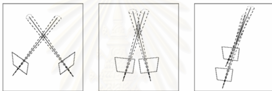
รูปที่ 3.8 ความผิดพลาดจากการฉายกลับของรังสีจากกล้องทั้งสองตัว [5]
