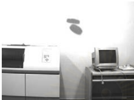
รูปที่ 2.4 คอมพิวเตอร์เฟดจากการถ่ายภาพวัตถุที่มีการเคลื่อนที่โดยใช้กล้องที่สแกนแบบอินเทอร์เลซ
