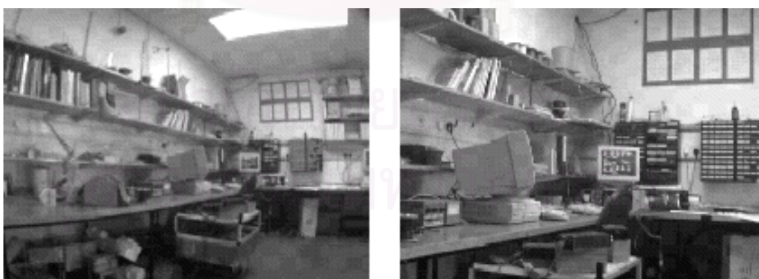
รูปที่ 3.6 (a) ภาพมีความบิดเบี้ยวมากอันเนื่องมาจากการใช้เลนส์ความยาวโฟกัสต่ำ
