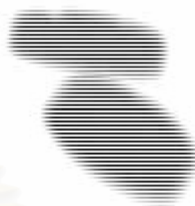
รูปที่ 2.4 คอมพิวเตอร์เฟดจากการถ่ายภาพวัตถุที่มีการเคลื่อนที่โดยใช้กล้องที่สแกนแบบอินเทอร์เลซ
