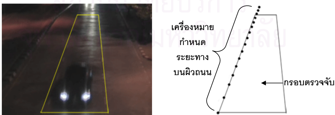
รูปที่ 4.3 ภาพจริงของมุม 0 องศา ที่มุม 35 องศา กับเครื่องหมายกำหนดระยะทางบนผิวถนน
