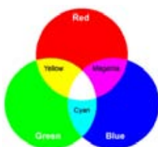
รูปที่ 2.6 ระบบสีแบบบวก (additive colors system)
