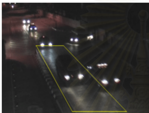
รูปที่ 4.6 ภาพจริงของมุม 20 องศาที่มุมกวด 20 องศา กับเครื่องหมายกำหนดระยะทางบนผิวถนน
