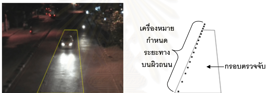
รูปที่ 4.2 ภาพจริงของมุม 0 องศา ที่มุมกอด 20 องศา กับเครื่องหมายกำหนดระยะทางบนผิวถนน
