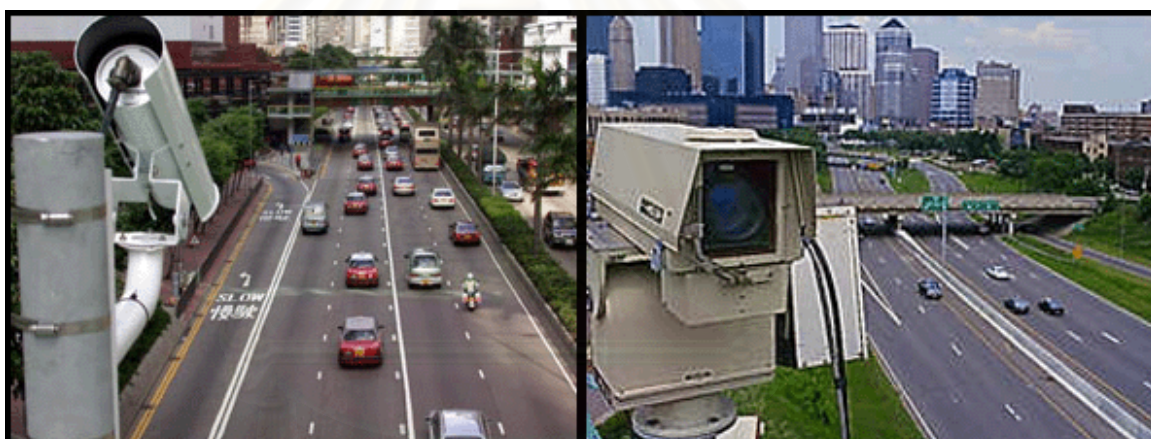
รูปที่ 1.4 ลักษณะการติดตั้งกล้องประมวลผลภาพในการใช้งาน [5]
