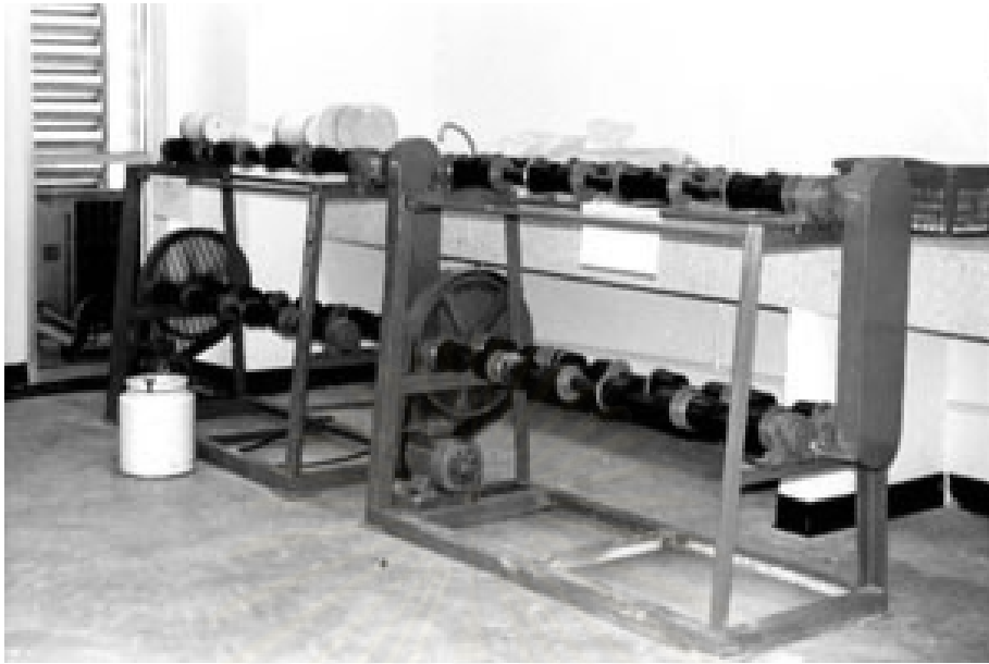
รูปที่ 3.3 เครื่องบดผสมชนิดราง
