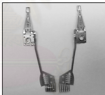
รูปที่ 1.2 หัวอ่านและบันทึก หรือ HGA
