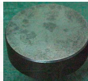
ชิ้นงานที่มีผิวด้านล่างได้ระนาบ (ชิ้นงานขนาดปานกลาง)
