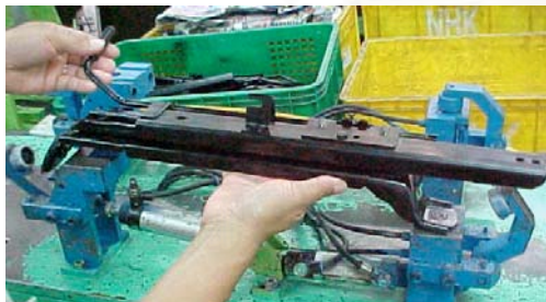
วางชิ้นงานลงบน Jig Check
