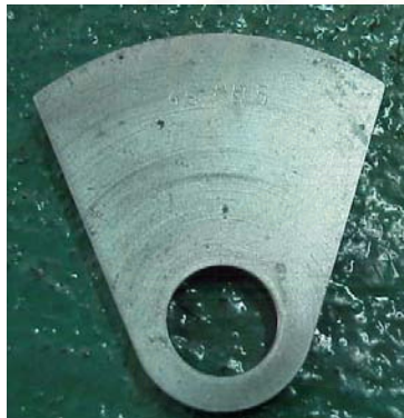
ชิ้นงานมาตรฐานที่ระบุขนาดเพื่อใช้ในการตั้งค่า 0 ของ Dial Gage
