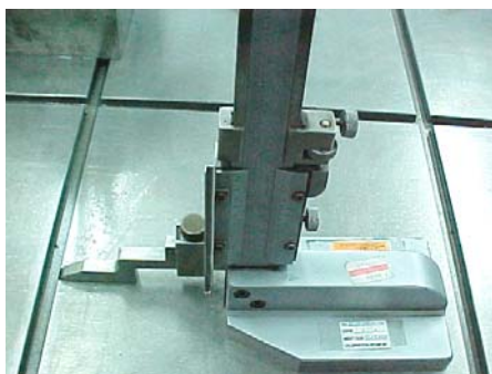
ภาพแสดงการวางเวอร์เนียไฮเกจลงบนโต๊ะระดับ
