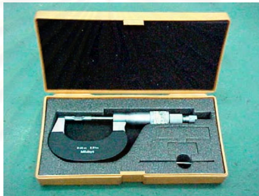
ภาพแสดงลักษณะการเก็บไมโครมิเตอร์หลังใช้งาน
