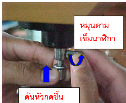
ประกอบหัวกดและตำแหน่งทดสอบเข้ากับเครื่องทดสอบ
