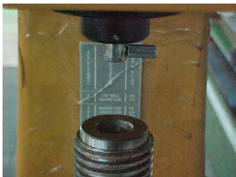
เครื่องทดสอบอยู่ในสภาพพร้อมประกอบหัวกด
