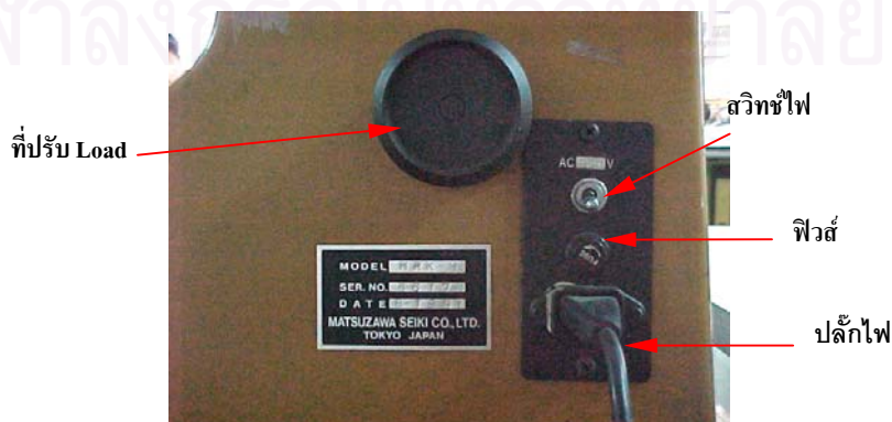
ภาพแสดงส่วนประกอบต่าง ๆ ของเครื่องวัดความแข็ง
