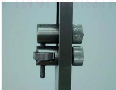
ภาพแสดงอุปกรณ์การปรับตั้งค่าสเกล (Provision)
