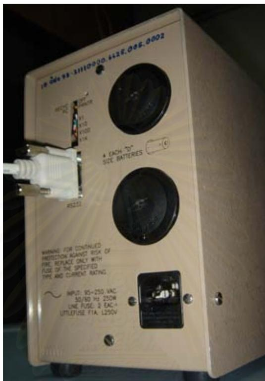
รูปที่ 3.11 เครื่องสเกลเลอร์/เรตมิเตอร์เชื่อมต่อไมโครคอมพิวเตอร์ด้วยพอร์ตอนุกรม
