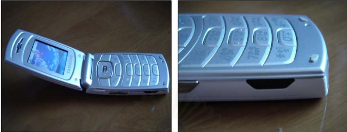
รูปที่ 3.6 โทรศัพท์เคลื่อนที่พร้อมพอร์ตอินฟราเรดของบริษัทซัมซุง รุ่น X-200
