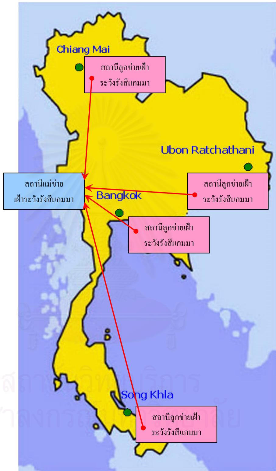
รูปที่ 3.2 แผนภาพจำลองการทำงานระบบเฟ้าระวังรังสีแกมมาในสิ่งแวดล้อมผ่านเครือข่ายโทรศัพท์เคลื่อนที่ ในการเฟ้าระวังรังสีแกมมาของประเทศไทย
