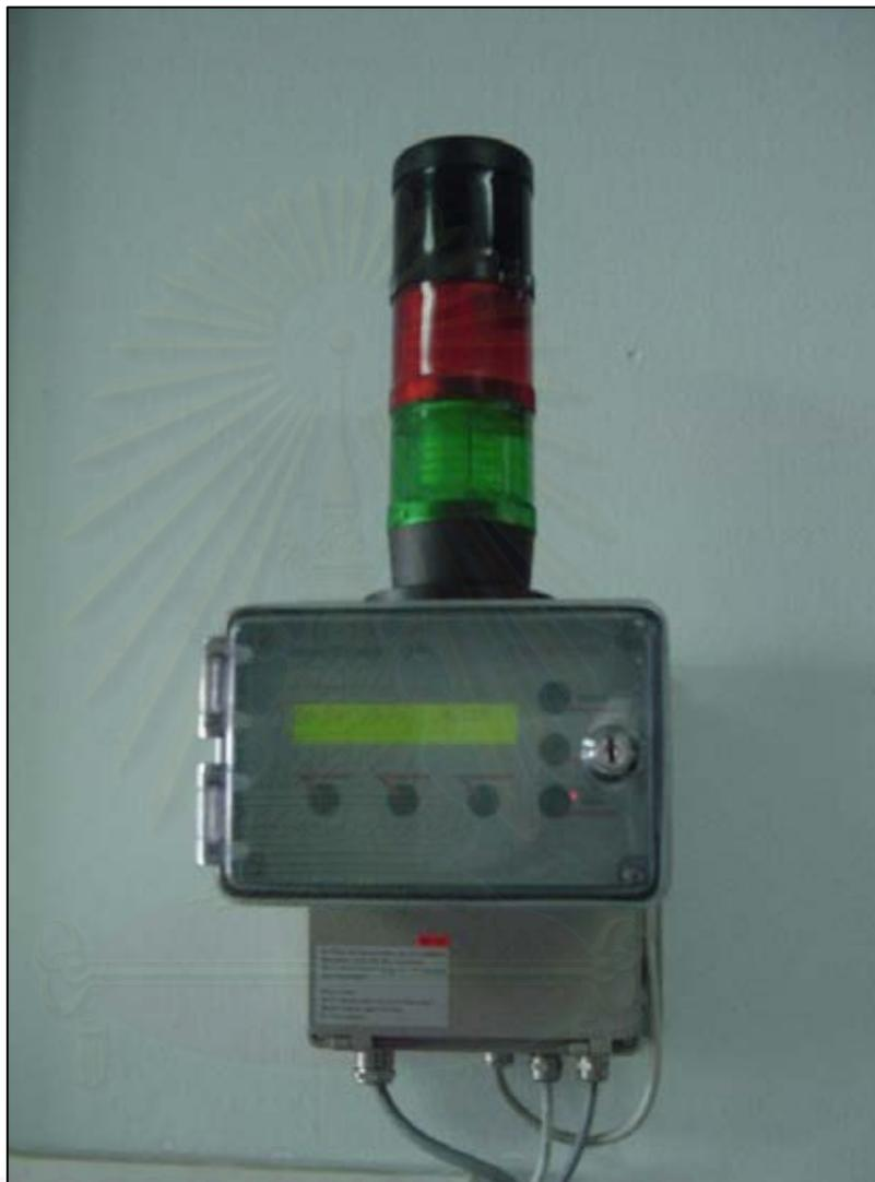
รูปที่ 2.7 อุปกรณ์ควบคุมการตรวจวัดในระบบเฝ้าระวังรังสีแกมมาในสิ่งแวดล้อม
