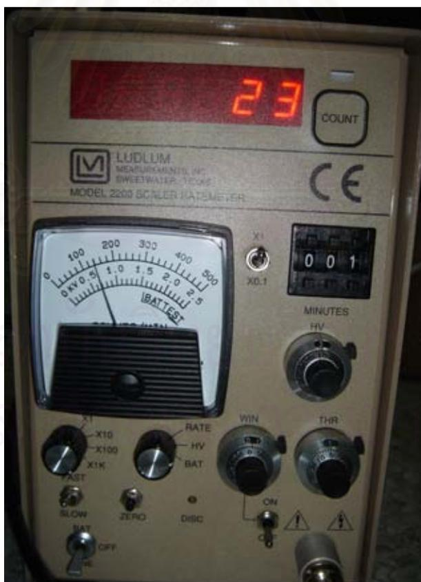
รูปที่ 4.2 ภาพแสดงจำนวนนับรังสีแกมมาที่ได้จากเครื่องสเกลเลอร์/เรตมิเตอร์ในการทดสอบการเชื่อมต่อรับส่งข้อมูลระหว่างเครื่องสเกลเลอร์/เรตมิเตอร์กับไมโครคอมพิวเตอร์
