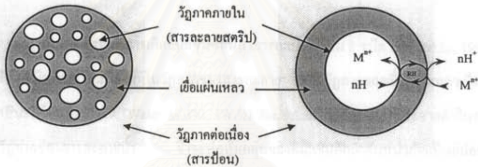
รูปที่ 2-5 แสดงลักษณะของอิมัลชันซ้อน (Double Emulsion) และกลไกการถ่ายโอนมวลในอิมัลชันซ้อน
