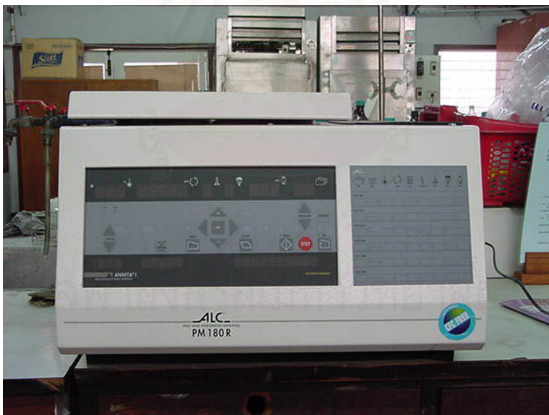
ภาพที่ ๓.4 เครื่องหมุนเหวี่ยงความเร็วสูงชนิดควบคุมอุณหภูมิ (ANNITA®| ALC , PM 180R)
