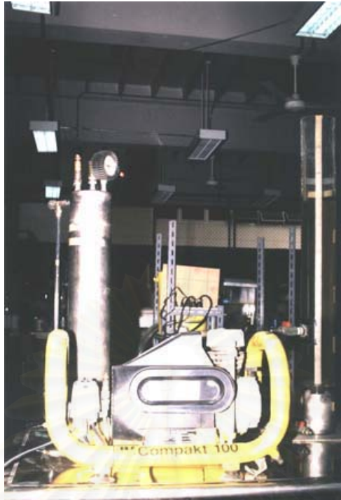
รูปที่ 4.22 ชุดการทดลอง DAF ในระดับห้องปฏิบัติการ
