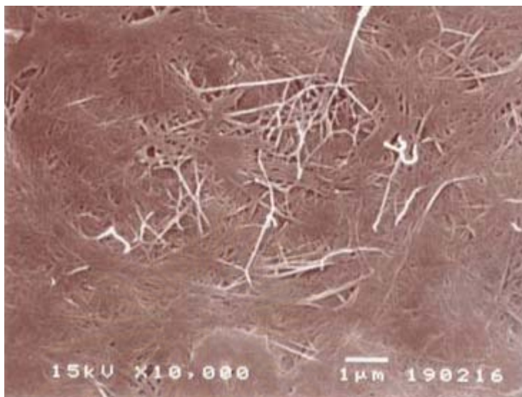
รูปที่ 5.33 ภาพพื้นผิวของฟิล์มเซลลูโลสจากแบคทีเรียที่ได้จากการทำให้บริสุทธิ์โดยวิธีการต้มตามวิธีที่ 4.3.2.3 แล้วปรับสภาพด้วยสารละลายกรดไฮโดรคลอริกเข้มข้น 3 โมลาร์ เป็นเวลา 9 วัน แล้วปรับสภาพความเป็นกรด-ด่างเป็นกลาง ด้วยกลั่นกรองจุลทรรศน์อิเล็กตรอนแบบส่องกราด ที่กำลังขยาย 10,000 เท่า
