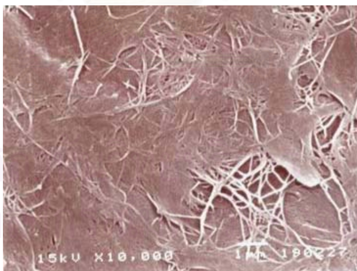
รูปที่ 5.46 ภาพพื้นผิวของฟิล์มเซลลูโลสจากแบคทีเรียที่ได้จากการทำให้บริสุทธิ์โดยวิธีการต้มตามวิธีที่ 4.3.2.3 แล้วปรับสภาพด้วยสารละลายกรดไฮโดรคลอริกเข้มข้น 3 โมลาร์ เป็นเวลา 1.5 เดือน แล้วปรับสภาพความเป็นกรด-ด่างเป็นกลางด้วยกล้องกล้องจุลทรรศน์อิเล็กตรอนแบบส่องกราด ที่กำลังขยาย 10,000 เท่า
