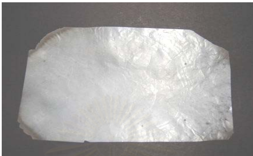
รูปที่ 5.5 แสดงลักษณะของฟิล์มที่ได้จากการทำให้บริสุทธิ์โดยการล้างด้วยน้ำกลั่นตามวิธีที่ 4.3.2.1 โดยไม่ผ่านการปรับสภาพของอุณหภูมิ
