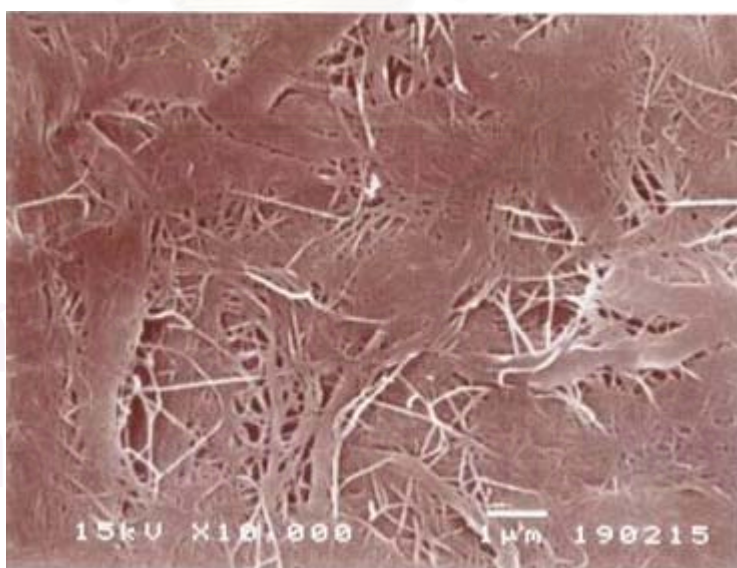
รูปที่ 5.32 ภาพพื้นผิวของฟิล์มเซลลูโลสจากแบคทีเรียที่ได้จากการทำให้บริสุทธิ์โดยวิธีการต้มตามวิธีที่ 4.3.2.3 แล้วปรับสภาพด้วย สารละลายกรดไฮโดรคลอริกเข้มข้น 1 โมลาร์ เป็นเวลา 9 วัน แล้วปรับสภาพความเป็นกรด-ด่างเป็นกลาง ด้วยกลั่นกรองจุลทรรศน์อิเล็กตรอนแบบส่องกราด ที่กำลังขยาย 10,000 เท่า
