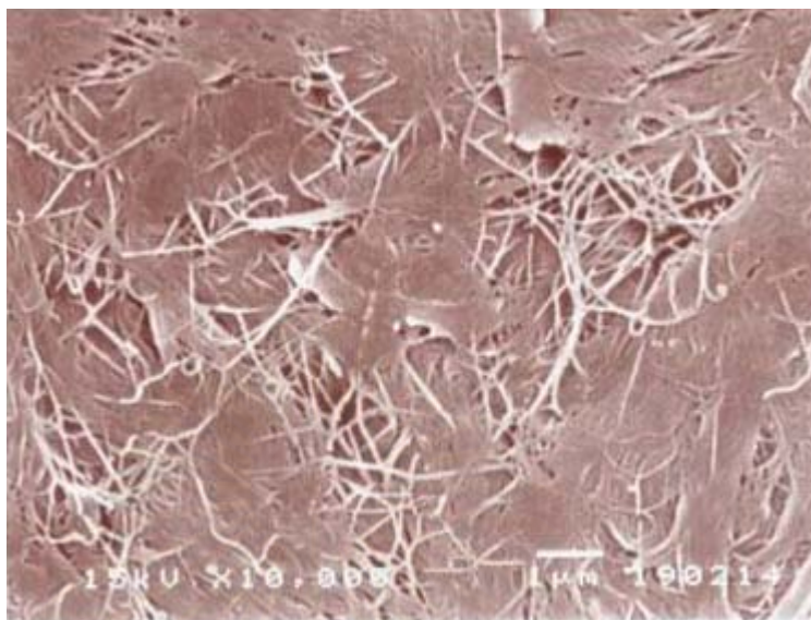
รูปที่ 5.31 ภาพพื้นผิวของฟิล์มเซลลูโลสจากแบคทีเรียที่ได้จากการทำให้บริสุทธิ์โดยวิธีการต้มตามวิธีที่ 4.3.2.3 และไม่ผ่านการปรับสภาพ ด้วยกลั่นกรองจุลทรรศน์อิเล็กตรอนแบบส่องกราดที่กำลังขยาย 10,000 เท่า
