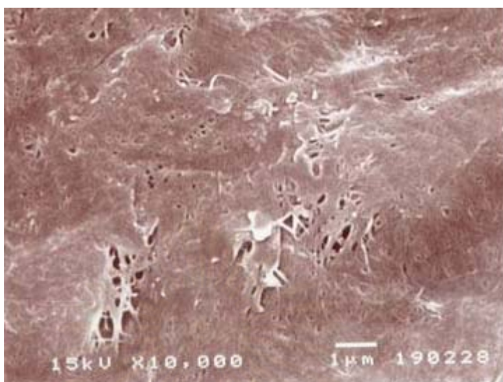
รูปที่ 5.47 ภาพพื้นผิวของฟิล์มเซลลูโลสจากแบคทีเรียที่ได้จากการทำให้บริสุทธิ์โดยวิธีการต้มตามวิธีที่ 4.3.2.3 แล้วปรับสภาพด้วยสารละลายกรดไฮโดรคลอริกเข้มข้น 5 โมลาร์ เป็นเวลา 1.5 เดือน แล้วปรับสภาพความเป็นกรด-ด่างเป็นกลางด้วยกลั่นกลั่นจุลทรรศน์อิเล็กตรอนแบบส่องกราด ที่กำลังขยาย 10,000 เท่า
