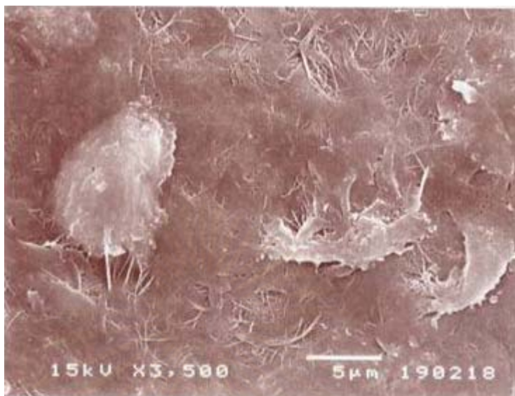
รูปที่ 5.35 ภาพพื้นผิวของฟิล์มเซลลูโลสจากแบคทีเรียที่ได้จากการทำให้บริสุทธิ์โดยวิธีการต้มตามวิธีที่ 4.3.2.3 แล้วปรับสภาพด้วยสารละลายกรดไฮโดรคลอริกเข้มข้น 1 โมลาร์เป็นเวลา 15 วัน แล้วปรับสภาพความเป็นกรด-ด่างเป็นกลาง ด้วยกลั่นกรองด้วยจุลทรรศน์อิเล็กตรอนแบบส่องกราด ที่กำลังขยาย 3,500 เท่า
