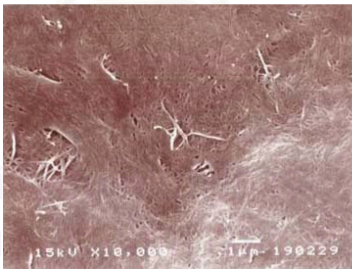
รูปที่ 5.48 ภาพพื้นผิวของฟิล์มเซลลูโลสจากแบคทีเรียที่ได้จากการทำให้บริสุทธิ์โดยวิธีการต้มตามวิธีที่ 4.3.2.3 แล้วปรับสภาพด้วยสารละลายกรดไฮโดรคลอริกเข้มข้น 7 โมลาร์ เป็นเวลา 1.5 เดือน แล้วปรับสภาพความเป็นกรด-ด่างเป็นกลางด้วยกลั่นกลั่นจุลทรรศน์อิเล็กตรอนแบบส่องกราด ที่กำลังขยาย 10,000 เท่า
