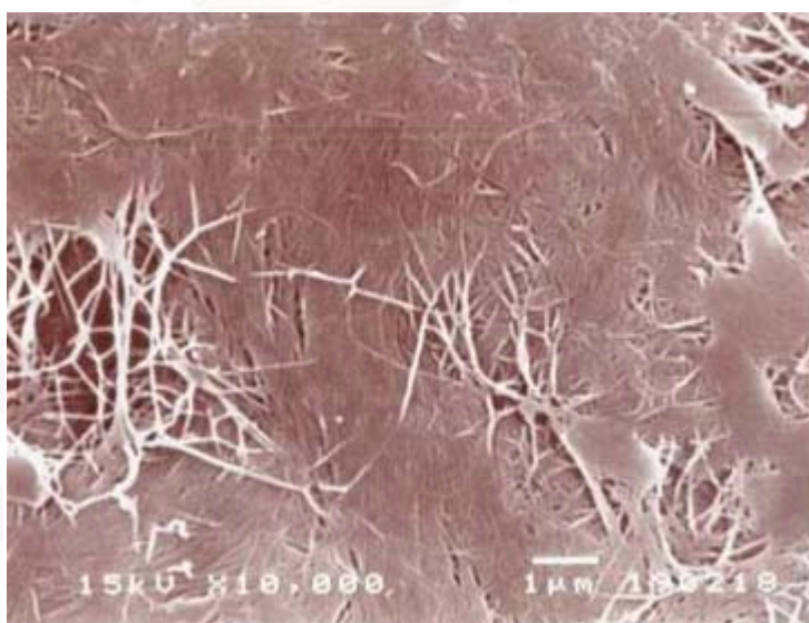
รูปที่ 5.36 ภาพพื้นผิวของฟิล์มเซลลูโลสจากแบคทีเรียที่ได้จากการทำให้บริสุทธิ์โดยวิธีการต้มตามวิธีที่ 4.3.2.3 แล้วปรับสภาพด้วยสารละลายกรดไฮโดรคลอริกเข้มข้น 1 โมลาร์เป็นเวลา 15 วัน แล้วปรับสภาพความเป็นกรด-ด่างเป็นกลาง ด้วยกลั่นกรองด้วยจุลทรรศน์อิเล็กตรอนแบบส่องกราด ที่กำลังขยาย 10,000 เท่า
