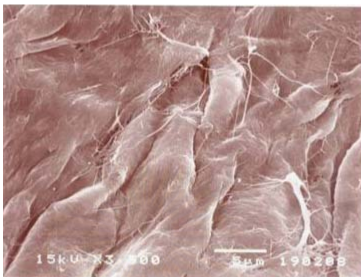
รูปที่ 5.21 ภาพพื้นผิวของฟิล์มเซลลูโลสจากแบคทีเรียที่ได้จากการทำให้บริสุทธิ์โดยการล้างด้วยน้ำกลั่นตามวิธีที่ 4.3.2.1 แล้วปรับสภาพด้วยสารละลายโซเดียมไฮดรอกไซด์ ที่ความเข้มข้น 0.5 เปอร์เซ็นต์ และ คาร์บอนไดออกไซด์ ด้วยกล้องกล้องจุลทรรศน์อิเล็กตรอนแบบส่องกราด ที่กำลังขยาย 3,500 เท่า
