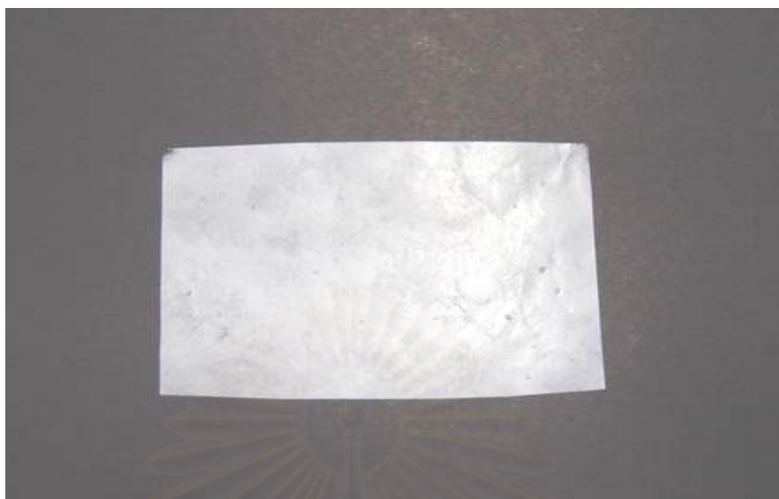
รูปที่ 5.3 แสดงลักษณะของฟิล์มที่ได้จากการทำให้บริสุทธิ์โดยการล้างด้วยน้ำกลั่นตามวิธี 4.3.2.1 แล้วปรับสภาพด้วยสารละลายกรดไฮโดรคลอริกเข้มข้น 5 โมลาร์ เป็นเวลา 24 ชั่วโมง แล้วปรับสภาพความเป็นกรด-ด่างเป็นกลาง
