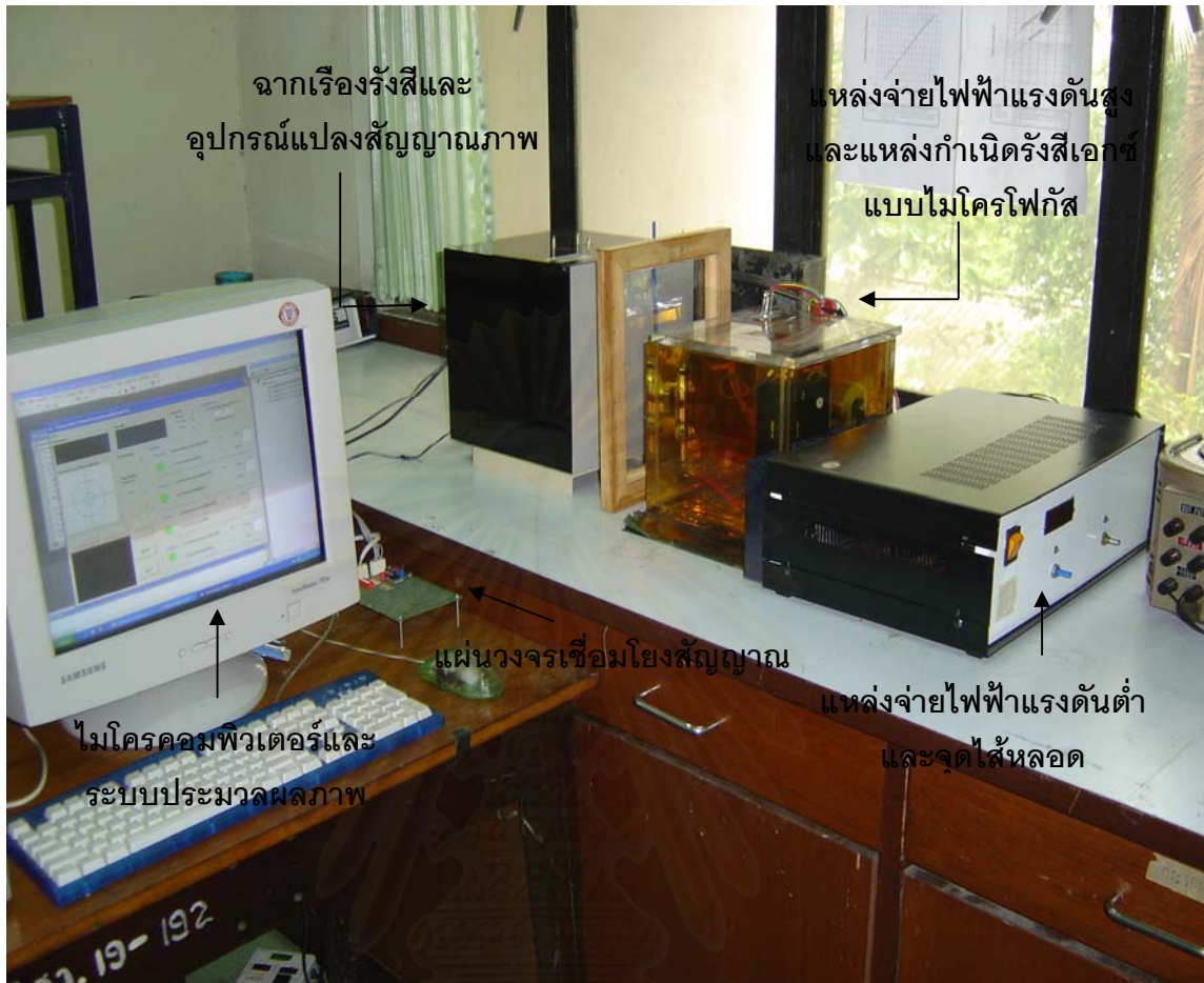
รูปที่ 3.16 ระบบตรวจสอบและควบคุมความหนาของฉนวนหุ้มสายไฟฟ้าที่พัฒนาขึ้น
