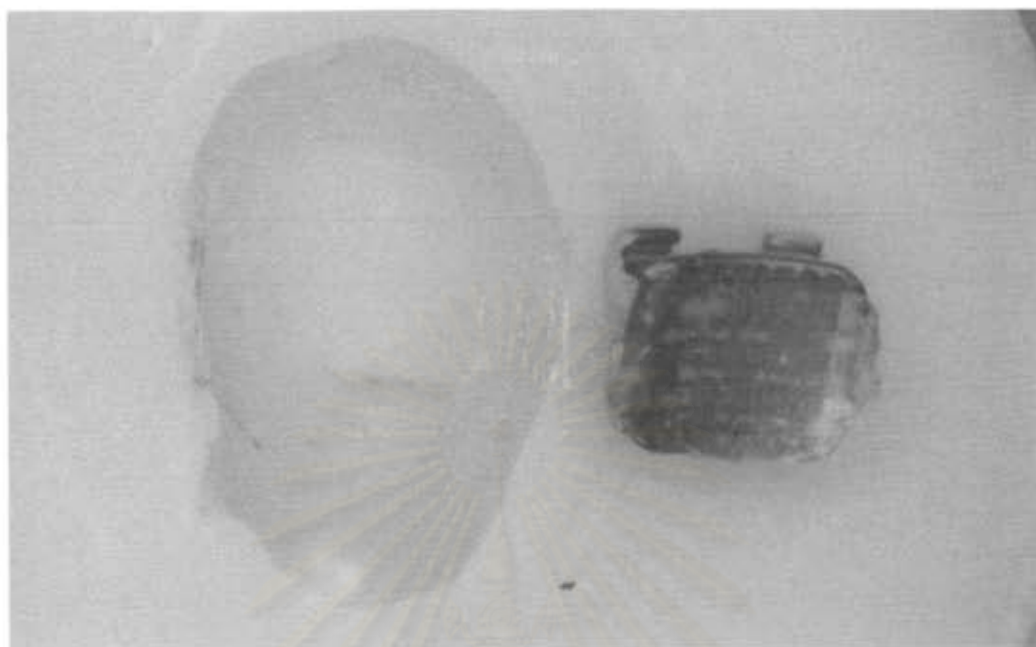
รูปที่ 52 ภาพแสดงความล้มเหลวในการยึดบริเวณผิวสัมผัส ระหว่างพอร์ซเลนและวัสดุยึด (กลุ่มที่ 2)
