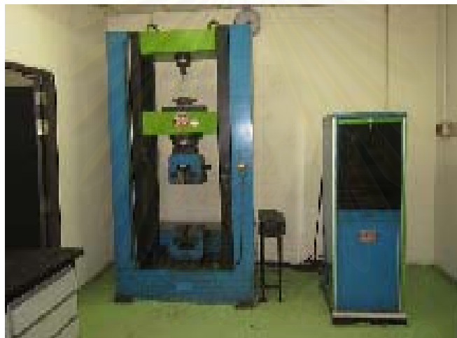
รูปที่ 3.3 RMU A18/300 แรงทดสอบสูงสุดอยู่ที่ 300 kN
