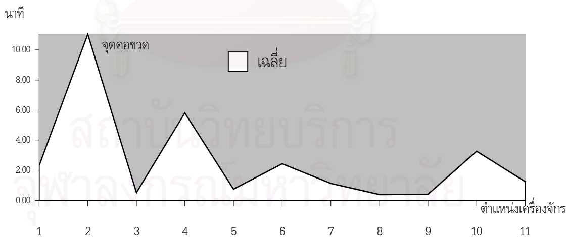
รูปที่ 6.7 ความสมดุลในการติดตั้งเครื่องจักร/อุปกรณ์ก่อนการปรับปรุง
