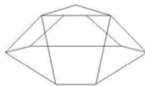
รูปที่ 3.2 โครงสร้างของแกนกลแบบสจ๊วตเมื่อมีการเปลี่ยนแปลงค่ามุม \theta_B และค่ามุม \theta_P
