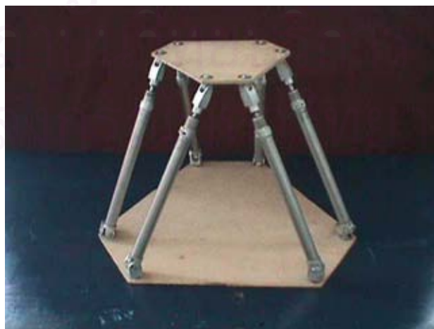
รูปที่ 2.8 แขนกลที่มีโครงสร้างแบบสจ๊วต
