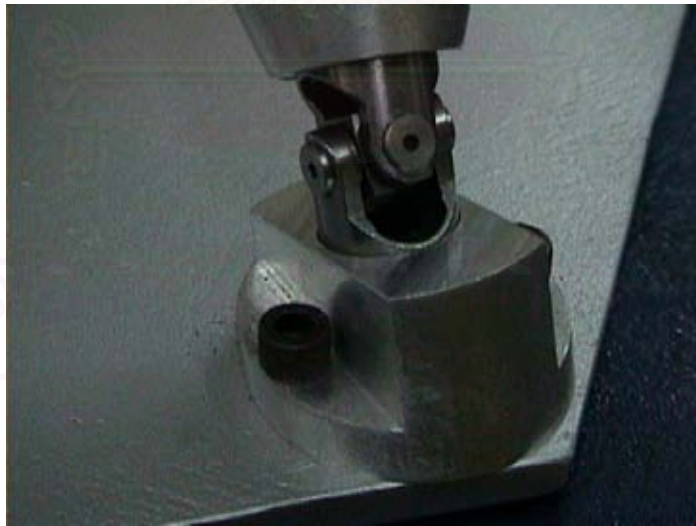
รูปที่ 3.15 ข้อต่อแบบ Universal joint ที่ประกอบอยู่กับส่วนฐาน
