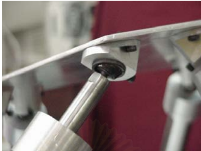
รูปที่ 3.16 ข้อต่อแบบ Spherical joint ที่ประกอบอยู่กับส่วนเคลื่อนที่
