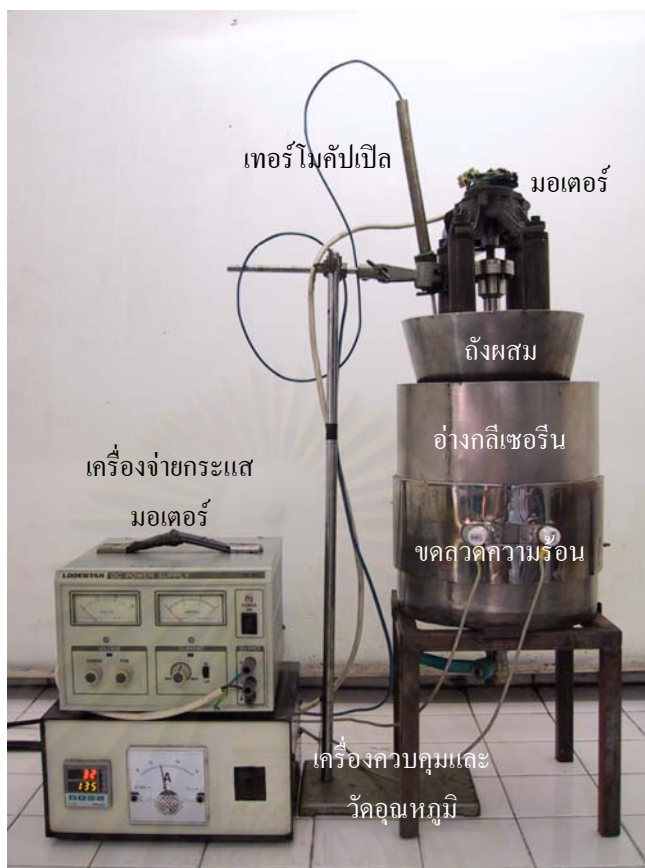
รูปที่ 3-1 อุปกรณ์ที่ใช้ในการหลอมซัลเฟอร์โพลีเมอร์และกวนผสมกากกัมมันตรังสี
