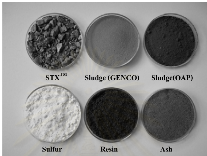
รูปที่ 3-3 ลักษณะของ STX™ กัมมะถัน และกากกัมมันตรังสีประเภทต่าง ๆ
