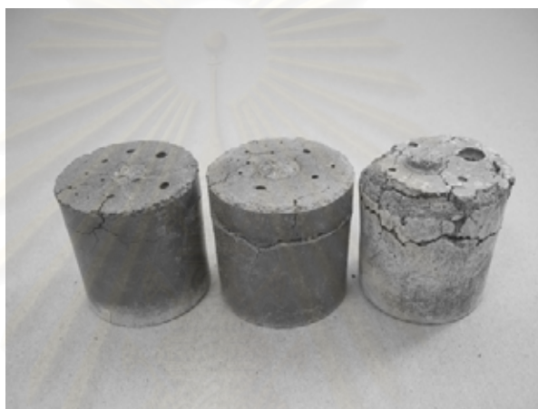
รูปที่ 4-4 ผลิตภัณฑ์กากฉนึ่กประเภทเรซินหลังนำออกจากแบบ และ วางทิ้งไว้ในอากาศเป็นเวลา 24 ชั่วโมง
