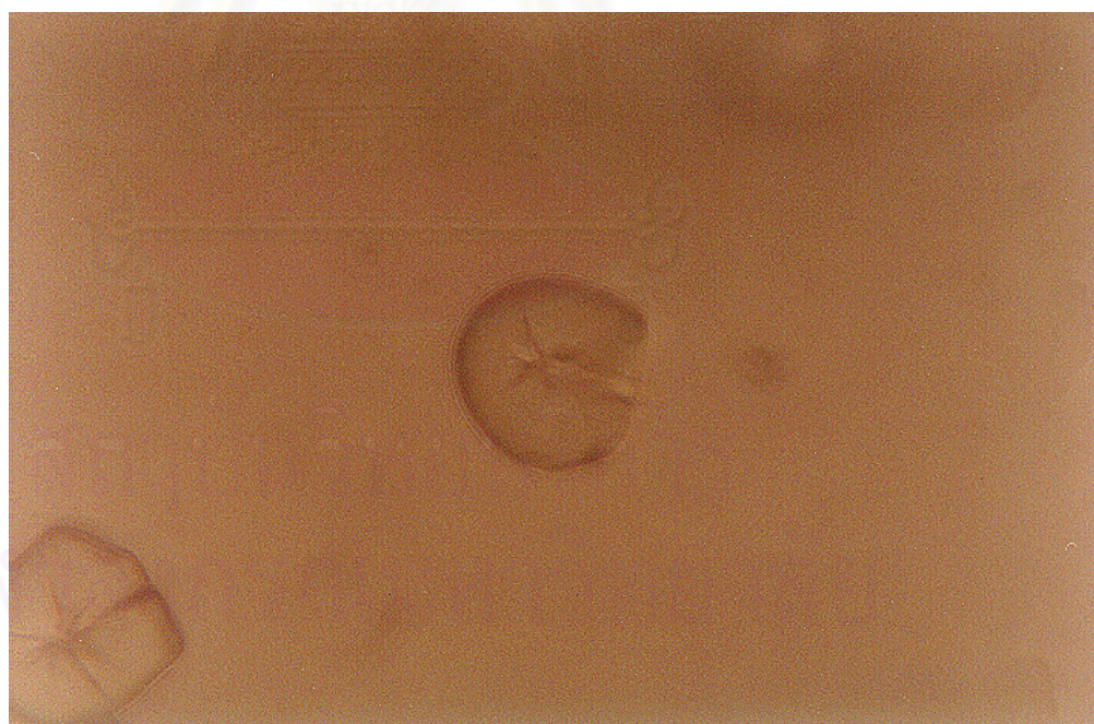
รูปที่ 6.2 รูปถ่ายจากกล้องจุลทรรศน์ของอนุภาคแป้งมันสำปะหลัง PURITY 21T (กำลังขยาย 100 เท่า)
