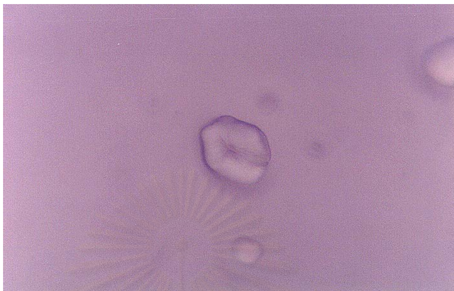
รูปที่ 6.1 รูปถ่ายจากกล้องจุลทรรศน์ของอนุภาคแป้งข้าวโพด PURITY 21A (กำลังขยาย 100 เท่า)
