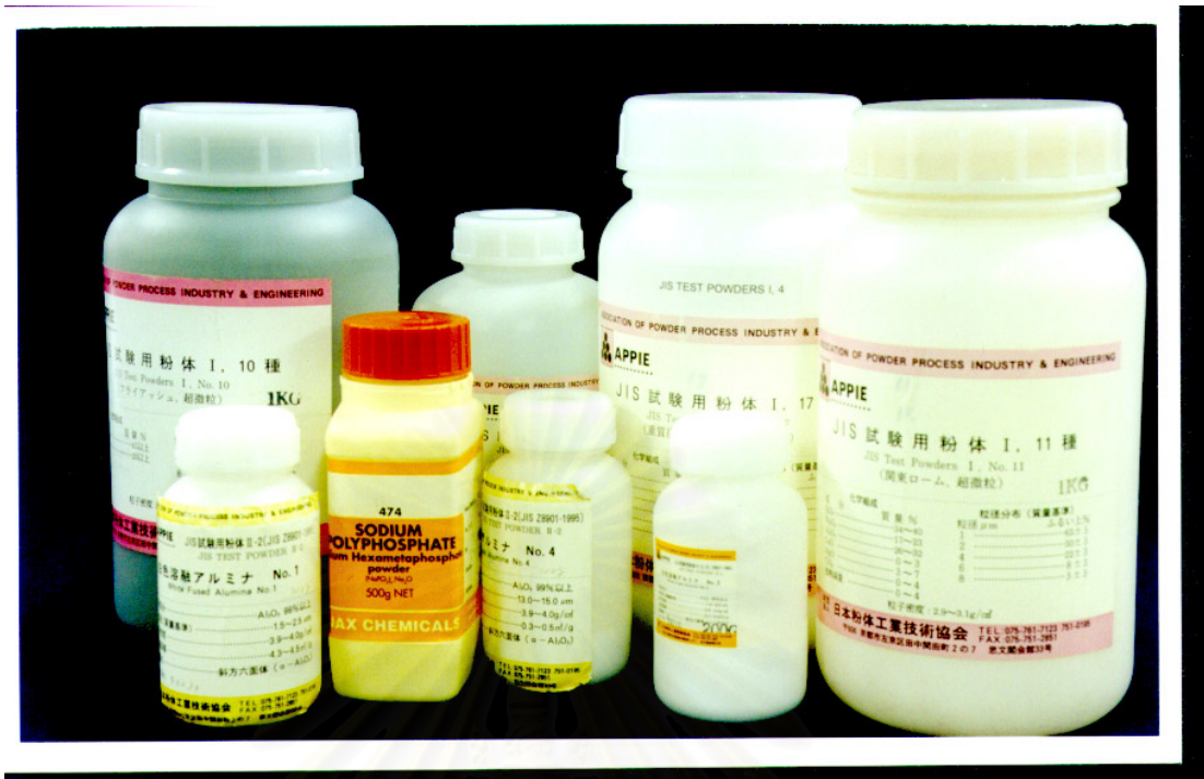
รูปที่ 5.1 อนุภาคมาตรฐานและสารช่วยในการกระจายตัว
