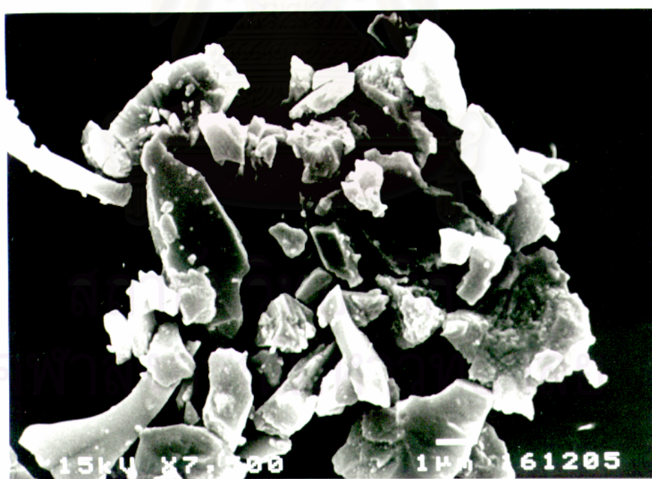
รูปที่ 5.3 รูปถ่ายจากเครื่อง SEM ของอนุภาค JIS TEST POWDER II, No.1 (กำลังขยาย 7,500 เท่า)
