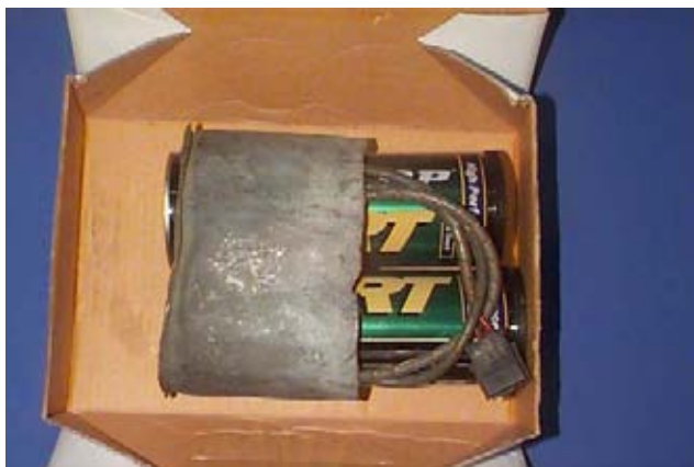
รูปที่ 3.16 ภาพถ่ายกล่องพัสดุไปรษณีย์ที่อยู่ในบรรจุแผ่นตะกั่ว สายไฟ และกระป๋องที่มีวัตถุระเบิดบรรจุอยู่
