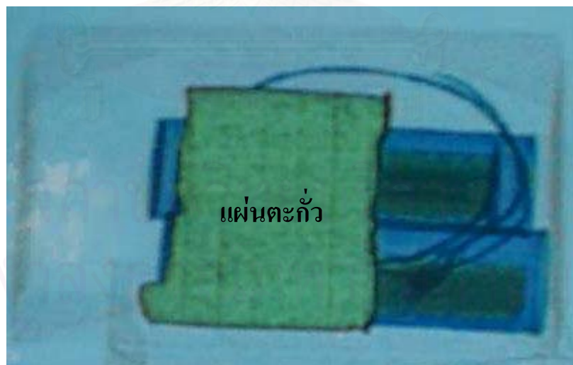
รูปที่ 4.18 รูปภาพสแกนด้วยรังสีเอกซ์ของกล่องพัสดุไปรษณีย์ซึ่งภายในบรรจุแผ่นตะกั่ว สายไฟ และกระป๋องที่มีวัตถุระเบิดบรรจุอยู่
