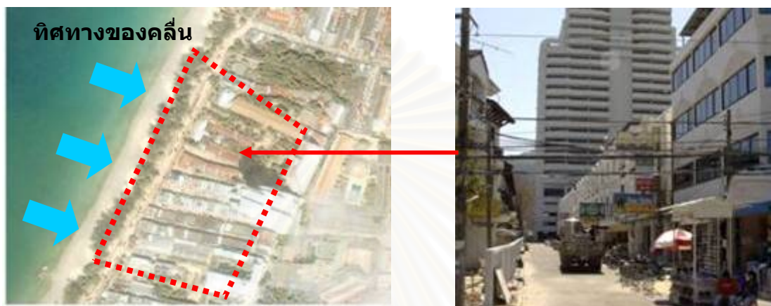
ภาพที่ 4.11 การกระทำของคลื่นต่อตัวอาคารที่ตั้งฉากกับแนวชายหาด
