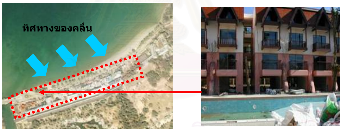
ภาพที่ 4.11 การกระทำของคลื่นต่อตัวอาคารที่ตั้งฉากกับแนวชายหาด
