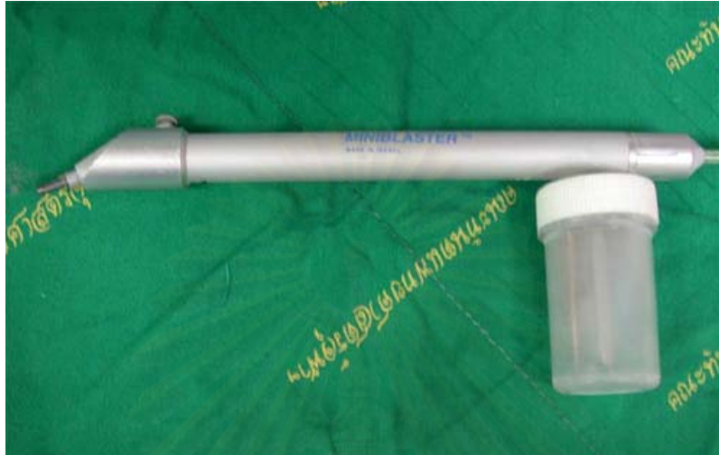
ภาพที่ 12 แสดงเครื่องเป่าทรายเพินบลาสเตอร์ทู (Airborne particle abrader, PenBlaster II, Shofu Inc , Kyoto , Japan) อุปกรณ์สำหรับเตรียมผิวทดสอบไอพีเอสเอ็มเพรสทู
