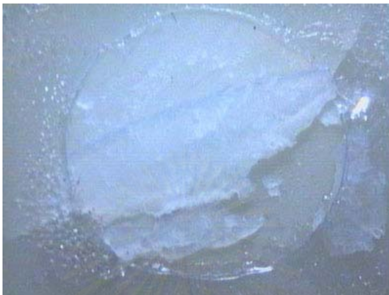
ภาพที่ 25 แสดงลักษณะการแตกหักแบบผสม ที่แตกระหว่างระหว่างรอยต่อพื้นผิวของเรซินซีเมนต์กับผิวทดสอบไอพีเอสเอ็มเพรสซูที่ด้านหนึ่ง ส่วนอีกด้านแตกในเนื้อของเรซินซีเมนต์
