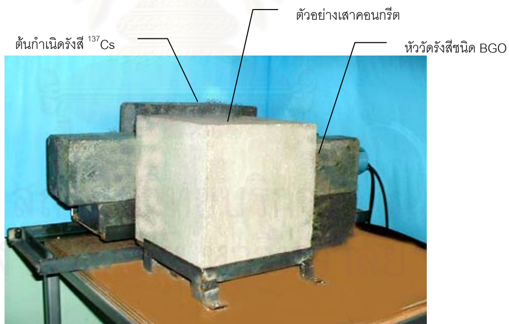
(ข) ระบบวัดรังสีเมื่อมีตัวอย่างเสาคอนกรีต
