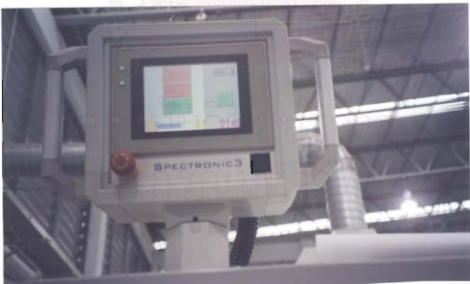
รูปที่ 3.7 หน้าจอคำสั่งสำหรับป้อนค่าการให้ความร้อน
