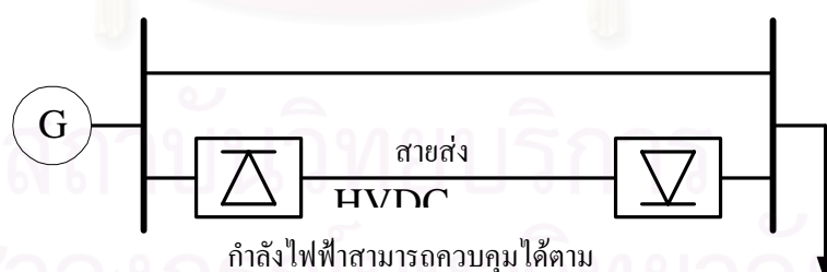
รูปที่ 2.15.ข การไหลของกำลังไฟฟ้าในสายส่งที่ต่อขนานกัน
