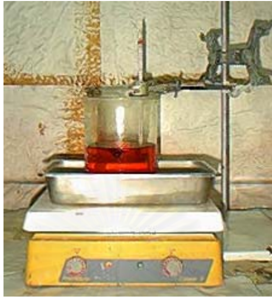
รูปที่ 3.3 ชุดอุปกรณ์สำหรับการทำปฏิกิริยาออกซิเดชันของซีเรียม
