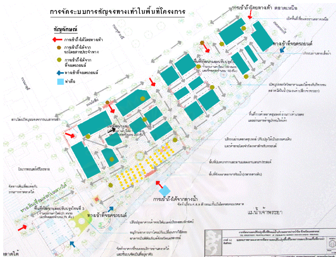
ภาพที่ 4.12 แสดงการจัดระบบการสัญจรทางเท้าภายในพื้นที่โครงการ
