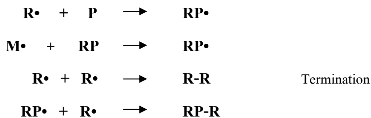
รูปที่ 2.4 กลไกการเกิดปฏิกิริยาของน้ำยาง (RH) ที่มีน้ำอยู่ด้วยกับ monofunctional monomer (M) โดยรังสี
