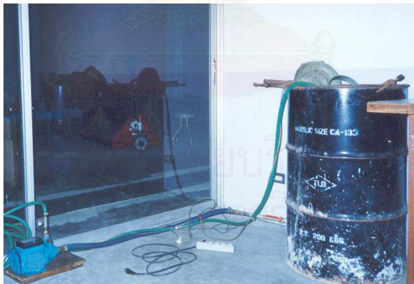
รูป 5.13 อุปกรณ์ระบายความร้อนของ Grip
