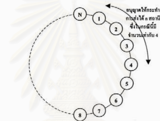
รูปที่ 2.5 การทำงานของระบบ URN
