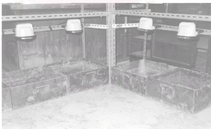
รูปที่ 3.3 การติดตั้งและจัดวางอุปกรณ์ที่ใช้ในการทดสอบการเปลี่ยนแปลงปริมาณความชื้นของดิน ภายหลังจากการรดผิวหน้าด้วยสารเคมี
