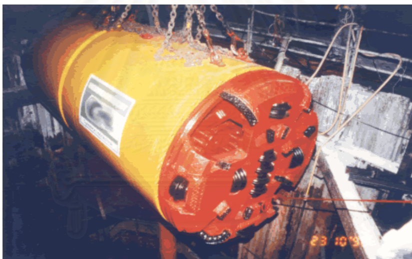
รูปที่ 2.2 หัวเจาะแบบ EPBS พร้อมหัวตัดหิน
