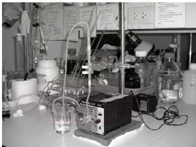
ภาพที่ 3 ตัวอย่างชุดแคดเมียมคอลัมน์ที่ดัดแปลงจาก Strickland and Parsons, 1972 และตัวอย่างเครื่องควบคุมอัตราการไหลของสารละลาย (peristatic pump รุ่น MasterFlex C/L™ Model 77120-60)
