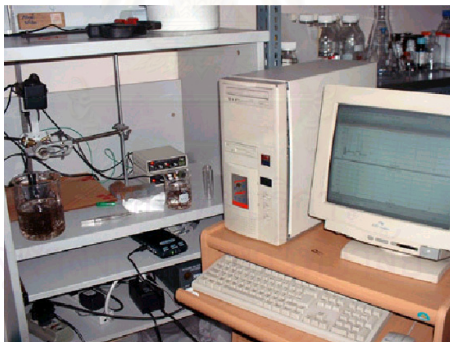
ภาพที่ 3-5 ชุดตรวจวัดการเรืองแสงของคลอโรฟิลล์ที่ต่อเข้ากับคอมพิวเตอร์สำหรับบันทึกข้อมูลตลอดระยะเวลาการทดลอง
