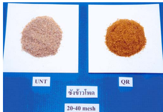
รูปที่ 5.2 เซลลูโลสที่ยังไม่ได้ปรับสภาพและควอเตอร์ไนซ์ ครอสส์ลิงค์เซลลูโลสที่เตรียมมาจากซังข้าวโพด
