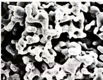
รูปที่ 2.5 ภาพถ่าย SEM ของอนุภาคหลังการ Sintering
