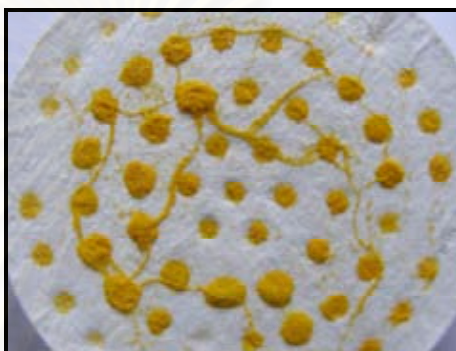
ภาพที่ 4.10 แสดงตะกอนที่เกิดขึ้นจากการแทนที่โลหะแพลทินัมด้วยผงโลหะสังกะสี
