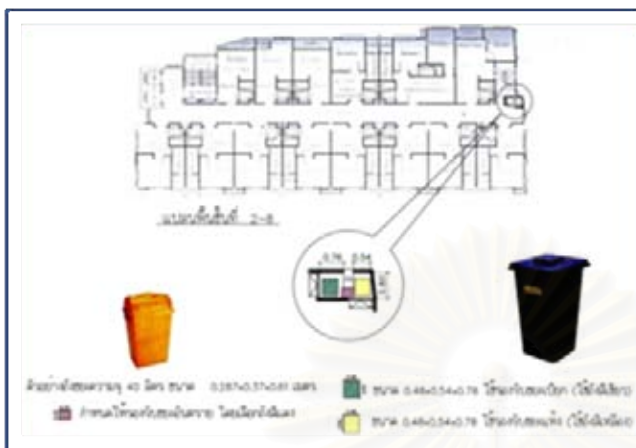
ภาพประกอบที่ 2.66 แสดง ตำแหน่งและลักษณะของที่พักขยะในแต่ละชั้นของโครงการ
