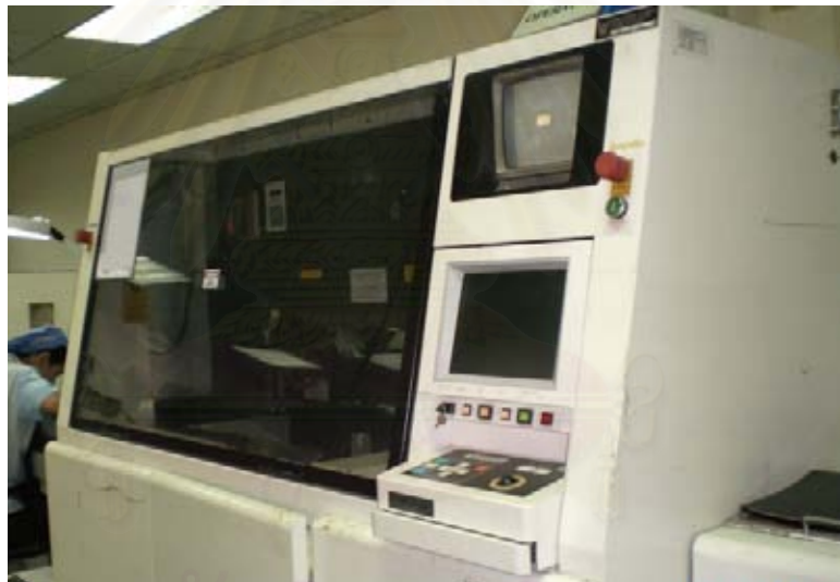
รูปที่ ก-15 Chip Component Mounting ทำหน้าที่ติดตั้ง Chip Mounting ลงบนแผ่นลายวงจร
