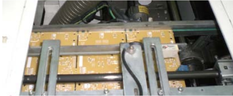
รูปที่ ค-4 แผ่นลายวงจรที่ยิง Component แล้วถูกส่งออกมาจากส่วน Axial Lead Component Insertion ไปยัง Unloader Board Stocker
