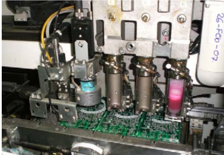
รูปที่ ก-14 ส่วนของ Adhesive Application กำลังยิงกาวลงบนแผ่นลายวงจรในจุดต่างๆ
