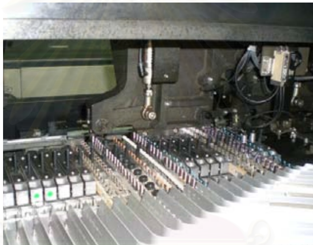
รูปที่ ค-8 ส่วนของการ Feed Component เข้าเครื่อง เพื่อยิงลงแผ่นลายวงจร
