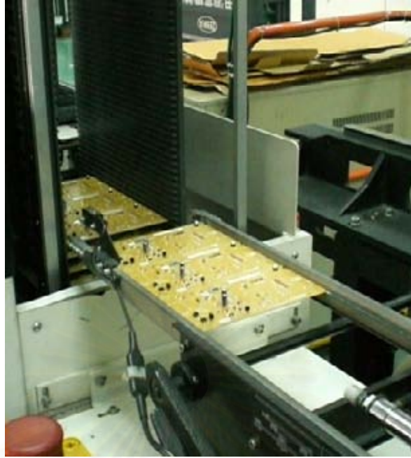
รูปที่ ค-10 แผ่นลายวงจรที่ยิงตัว Component ในแนวตั้งเรียบร้อยแล้ว ถูกลำเลียงเข้าไปเก็บใน Unloader Board Stocker
