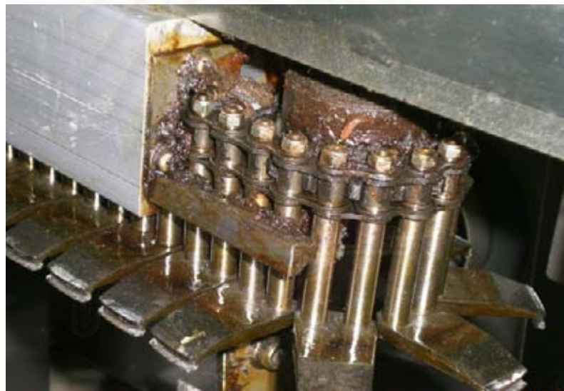
รูปที่ ค-25 Conveyor Finger เป็นซี่ฟันยึดจับชิ้นงาน
