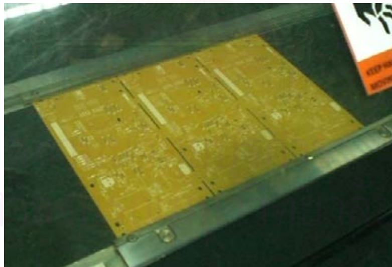
รูปที่ ค-3 แผ่นลายวงจรถูกส่งเข้ามาในส่วนของ Axial Lead Component Insertion เพื่อทำการยิง Component
