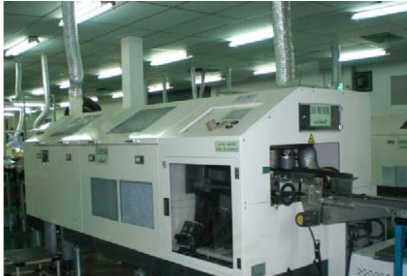
รูปที่ ค-21 ตัวเครื่อง Auto Soldering ภายนอก
