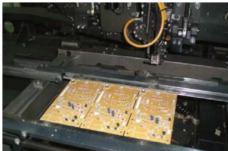
รูปที่ ค-9 แผ่นลายวงจรที่อยู่ในเครื่อง Radial ซึ่งกำลังยิง Component อยู่
