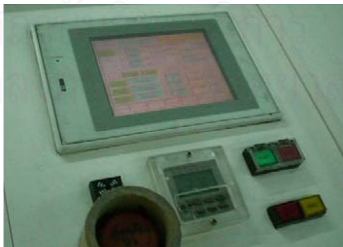
รูปที่ ค-23 แผงหน้าจอไว้ตั้งโปรแกรมควบคุมเครื่อง Auto Soldering
