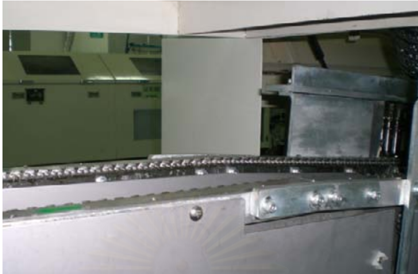
รูปที่ ค-28 Outlet Feeder Conveyor ทำหน้าที่ลำเลียงแผ่นลายวงจรออกจากเครื่องจักร
