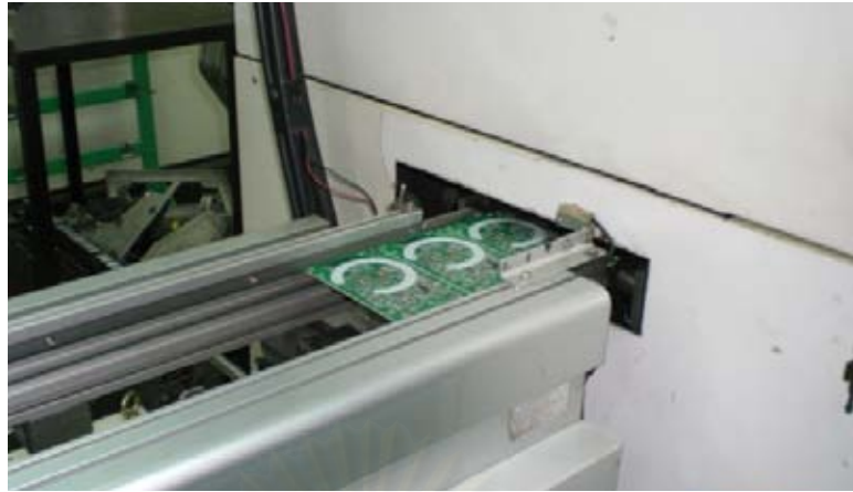
รูปที่ ค-18 แผ่นลายวงจรออกจาก Reflow Soldering ถูกลำเลียงออกด้วย Conveyor with Pull Arm
