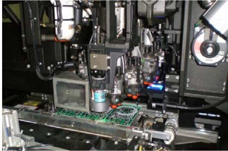
รูปที่ ค-16 ภายในส่วนของ Chip Component Mounting เครื่องจักรกำลังติดตั้ง Chip Mounting ลงบนแผ่นลายวงจร
