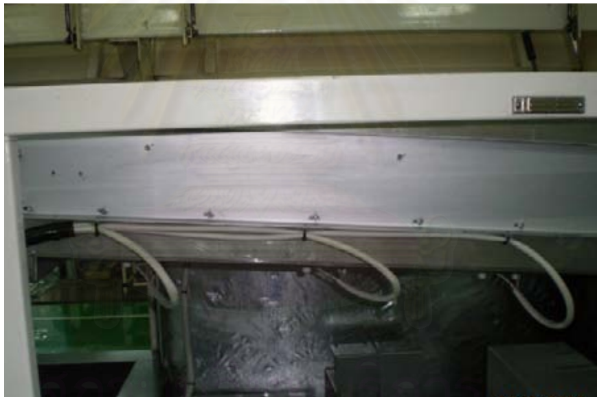
รูปที่ ค-27 Pre-Heater ทำหน้าที่อบความร้อนให้กับแผ่นลายวงจร
