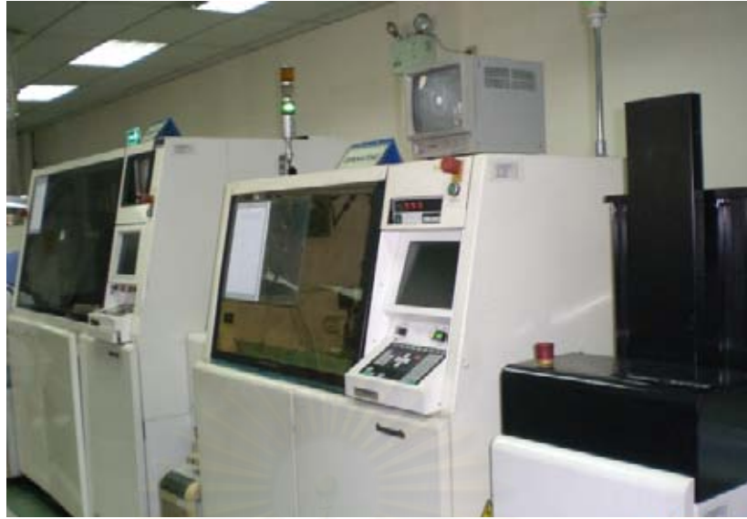
รูปที่ ก-12 ตัวเครื่อง SMT ในส่วนของ Adhesive Application และ Chip Component Mounting
