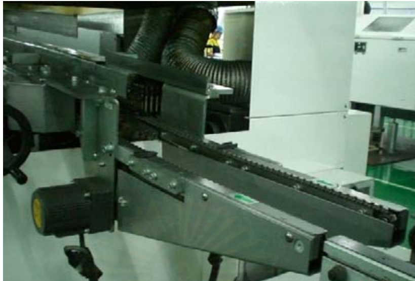
รูปที่ ค-24 Inlet Feeder Conveyor ทำหน้าที่ลำเลียงแผ่นลายวงจรเข้าเครื่องจักร
