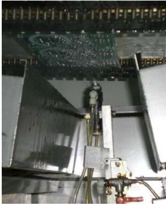
รูปที่ ค-30 Spray Nozzle Unit ทำหน้าที่ ฉีดน้ำฟลักซ์เคลือบที่แผ่นลายวงจรถองก่อนเข้าป้อตะกั่ว
