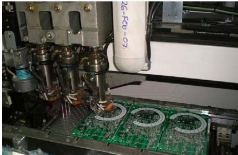
รูปที่ ก-13 ภายในส่วนของ Adhesive Application ทำหน้าที่ยิงกาวลงบนแผ่นลายวงจร
