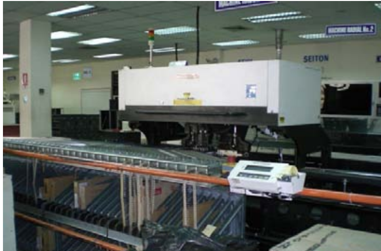
รูปที่ ค-7 ตัวเครื่อง Radial Machine ในส่วนของ Radial Lead Component Insertion
