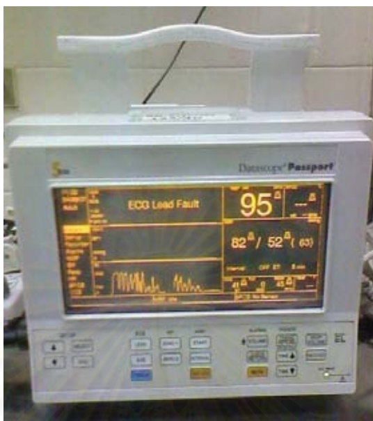
ภาพที่ 1 เครื่อง Datascope® Passport สำหรับบันทึกค่าสัญญาณชีพต่างๆ
