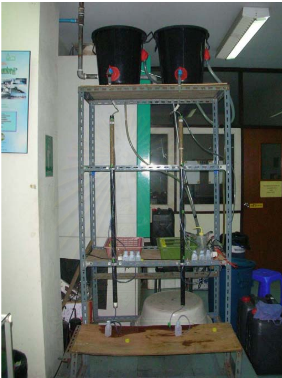
รูปที่ ๓.๕ อุปกรณ์ที่ใช้ในการทดสอบประสิทธิภาพในการดูดซับของแคดเมียม และสังกะสี โดยทำการทดลองแบบต่อเนื่องในคอลัมน์
