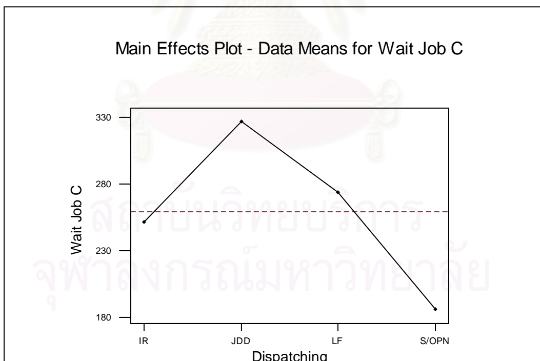
รูปที่ 5-162 ความสัมพันธ์ระหว่างกฎการจ่ายงานกับค่าเวลาการรอคอยการประกอบโดยเฉลี่ย ของงาน C ในระบบที่ผลิตชิ้นงาน โครงสร้างซับซ้อน
