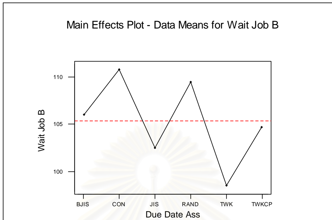
รูปที่ 5-24 ความสัมพันธ์ระหว่างกฎการกำหนดเวลาส่งมอบกับค่าเวลาการรอคอยการประกอบ โดยเฉลี่ยของงาน B ในระบบที่ผลิตชิ้นงาน โครงสร้างแบบแบน
