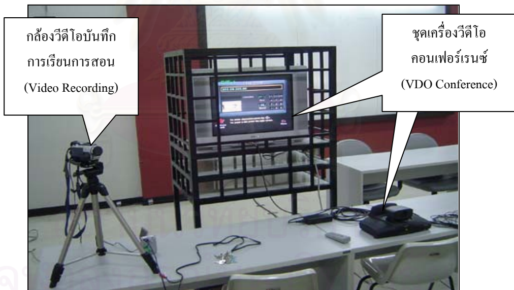
รูปที่ 4.9 ชุดอุปกรณ์ที่ใช้ในการเรียนการสอนผ่านทางไกล
