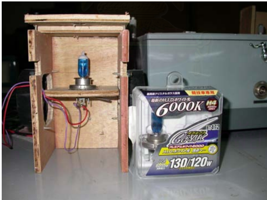
รูปที่ 6.3 หลอดฮาโลเจนไฟหน้ารถยนต์ที่อุณหภูมิสีเทียบเคียง 6000 K ที่กำลังงาน 60 W พร้อมชุดระบายความร้อน (พัดลมระบายอากาศ 2 ตัว)
