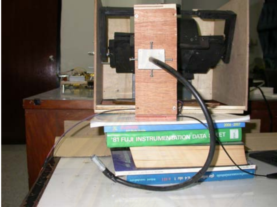
รูปที่ 6.5 เส้นใยนำแสงขณะปลายหนึ่งติดกับหลอดโฟโตมัลติพลายเออร์ ส่วนปลายอีกด้านติดด้วยสังกะสี
