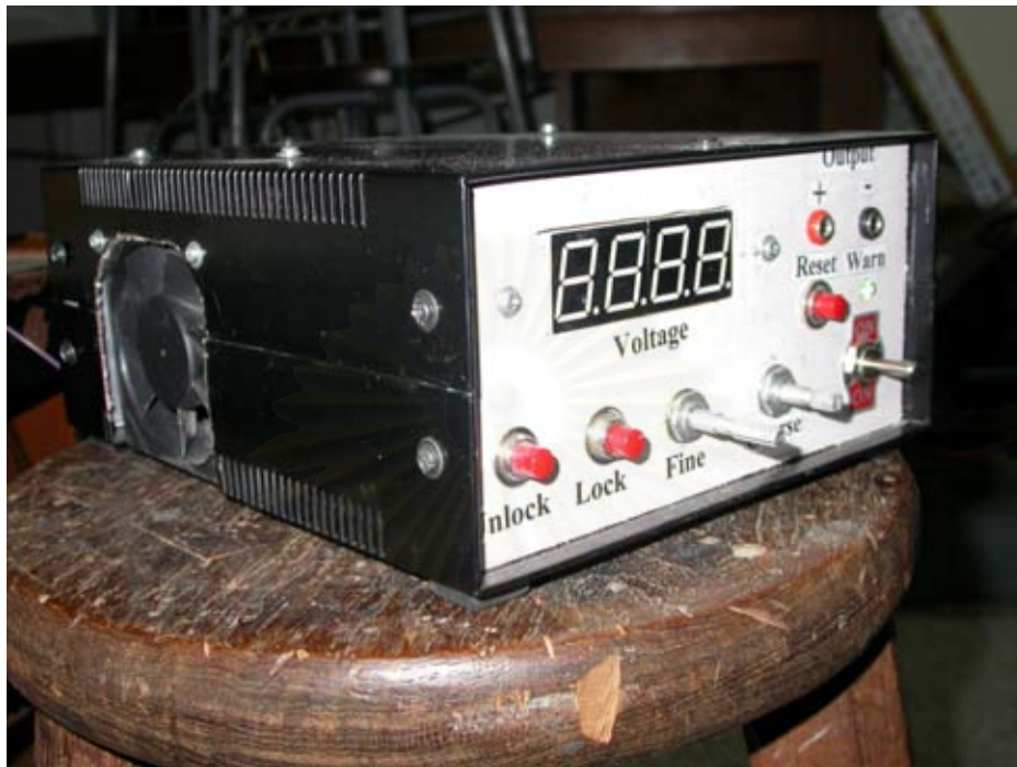
รูปที่ 6.7 เครื่องจ่ายกำลังไฟตรงแรงดันสูงโดยจ่ายให้หลอดไฟโคมัลติฟลายเออร์ที่แรงดัน 800 V
