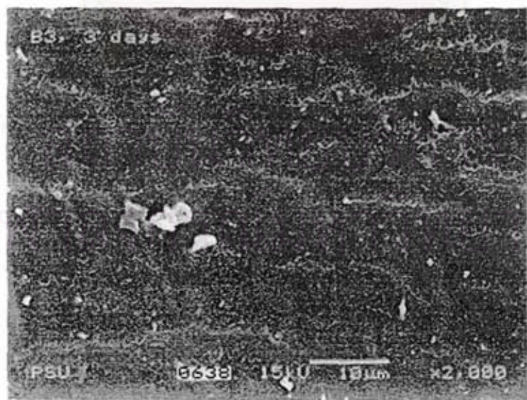
รูปที่ 6.1 ภาพถ่ายจากเครื่องSEMของชิ้นงานที่แช่ในพาราไซลีนเป็นเวลา 3 วัน (a) NR; (b) SBR; (c) B3 (50%SBR)
