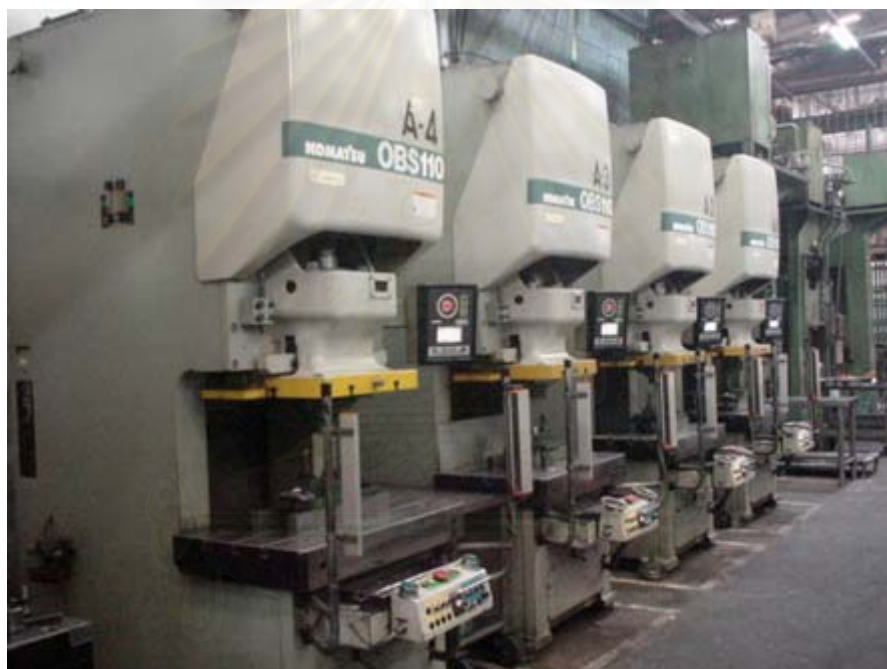
รูปที่ 3.6 เครื่องปั๊มขนาด 110 ตันที่วางเรียงติดต่อกัน
