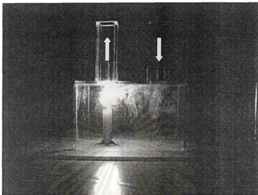
รูปที่ 4.17 ภาพแสดงการพาความร้อน โดยสังเกตจากการเคลื่อนที่ของควันรูปซึ่งเข้ามาจากท่อขวามือ ถูกดูด และปล่อยออกที่ท่อด้านซ้ายมือ เหนือตำแหน่งเปลวเทียน การดูดสังเกตได้ชัดเจนกว่าการปล่อย
