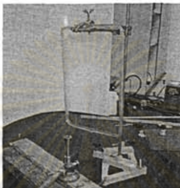
รูปที่ 4.19 การจัดชุดสาริตเครื่องการพาคความร้อนด้วยน้ำร้อน
